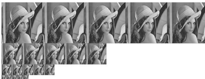
รูปที่ 3.7 ภาพที่ได้จากการลดขนาด 4 ระดับและลดรายละเอียด 5 ระดับ [18]
