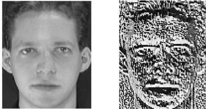
รูปที่ 3.2 ตัวอย่างรูปหลังจากการคำนวณด้วย Local Binary Patterns [14]
