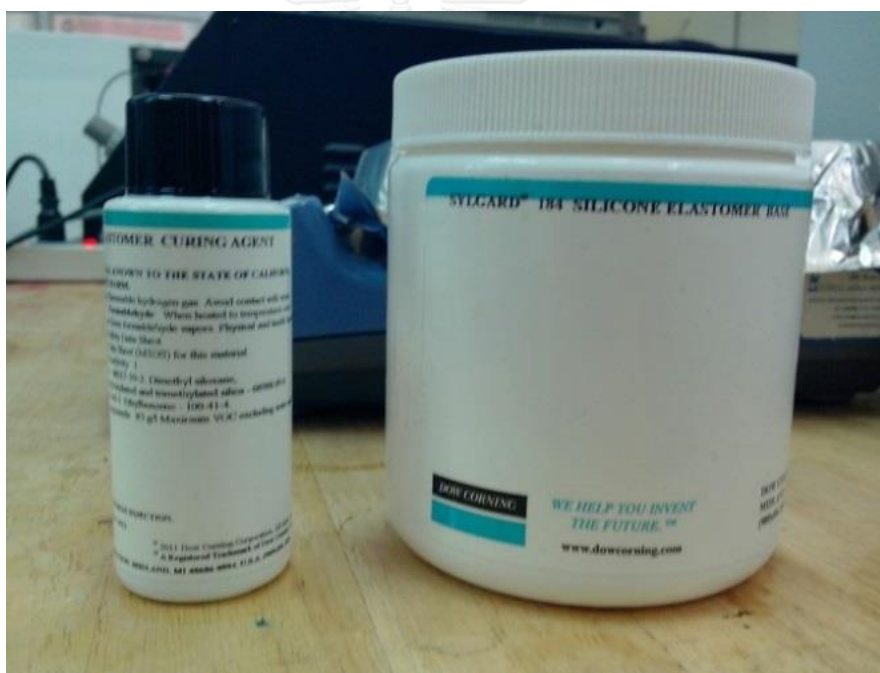
รูปที่ 3.3 ส่วนผสมของ PDMS (Polydimethylsiloxane) : Silicone Elastomer Base (ขวา) และ Silicone Elastomer Curing Agent (ซ้าย)
