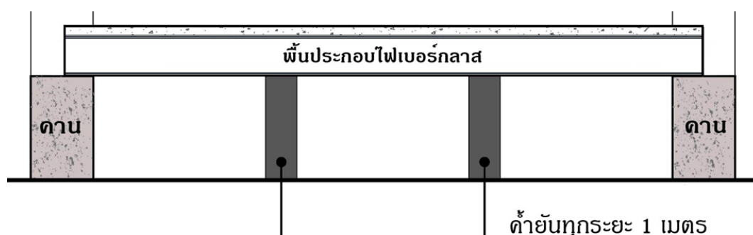
ภาพที่ 4.12 แสดงการค้ำยันเพื่อป้องกันการแอ่นตัวขณะเทคอนกรีตพื้น
