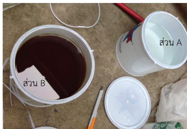
ภาพที่ 4.7 อีพ็อกซีประกอบไปด้วยส่วน A และ B (เรซิน และฮาร์ดเทนเนอร์)
