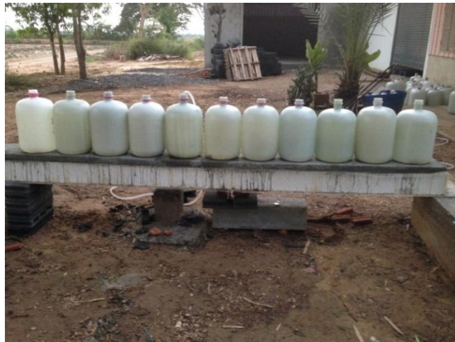
ภาพที่ 4.14 การทดสอบพื้นประกอบไฟเบอร์กลาส ตามมาตรฐาน มอก. 577 - 2531
