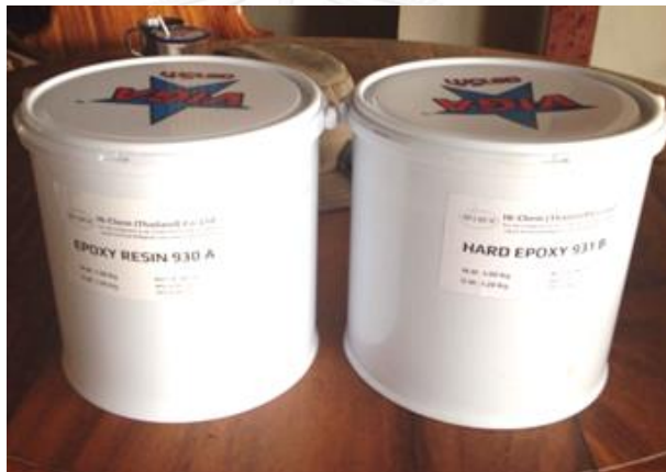
ภาพที่ 4.6 เตรียมอีพ็อกซีเพื่อยึดตาข่ายไฟเบอร์กลาสกับโพลีเอสเตอร์
