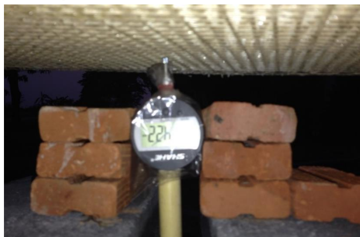
ภาพที่ 4.15 วัดการแอ่นตัวของพื้นประกอบไฟเบอร์กลาสและบันทึกข้อมูล บันทึกข้อมูลจากการทดสอบแผ่นพื้นประกอบไฟเบอร์กลาส ตามมาตรฐาน มอก.
