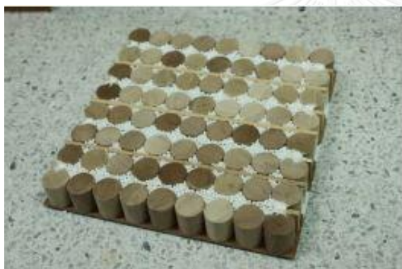
รูปที่ 16 ผนังไม้จริงที่มีการปิดช่องว่างระหว่างไม้ด้วยเม็ดโพลีโพลีสไตรีน
