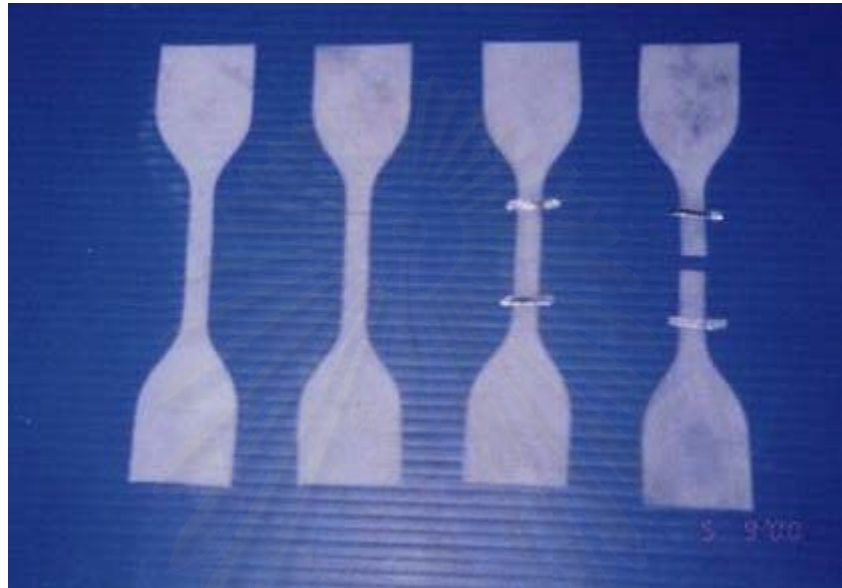
รูปที่ 3.8 ชิ้นตัวอย่างสำหรับการวัดความต้านทานแรงดึง
