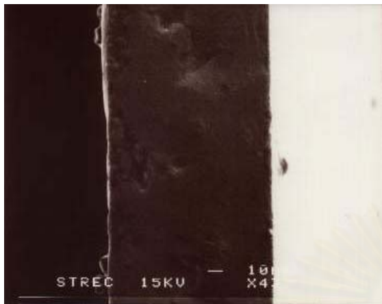
รูปที่ 4.17 ภาคตัดขวางของเยื่อแผ่นน้ำยางธรรมชาติ-พอลิอะครีลาไมด์ (60:40, 1 %wt EGDM networks, crosslinked PAM, semi-IPN membrane)
