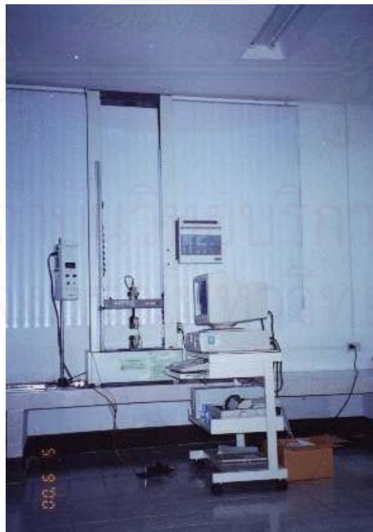
รูปที่ 3.9 เครื่อง Universal tester LLOYD Instruments LR 5K
