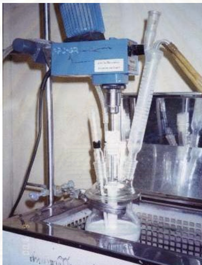
รูปที่ 3.3 ชุดปฏิบัติการและการทำปฏิกิริยาพอลิเมอร์ไอเซชันของพอลิอะครีลาไมด์
