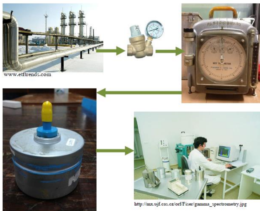
รูปที่ 3.1 กระบวนการตรวจวัดเรดอนจากท่อส่งก๊าซธรรมชาติ
