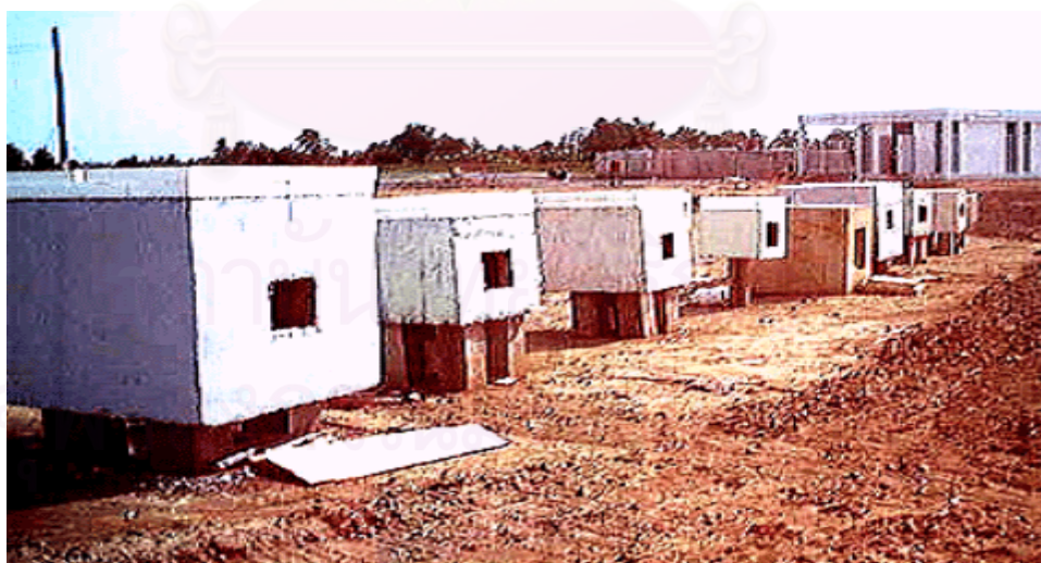
รูปที่ 4. 5 รูปแบบกล่องทดลองที่ใช้ทดสอบอิทธิพลของการถ่ายเทความร้อนผ่านเปลือกอาคารด้านบน
