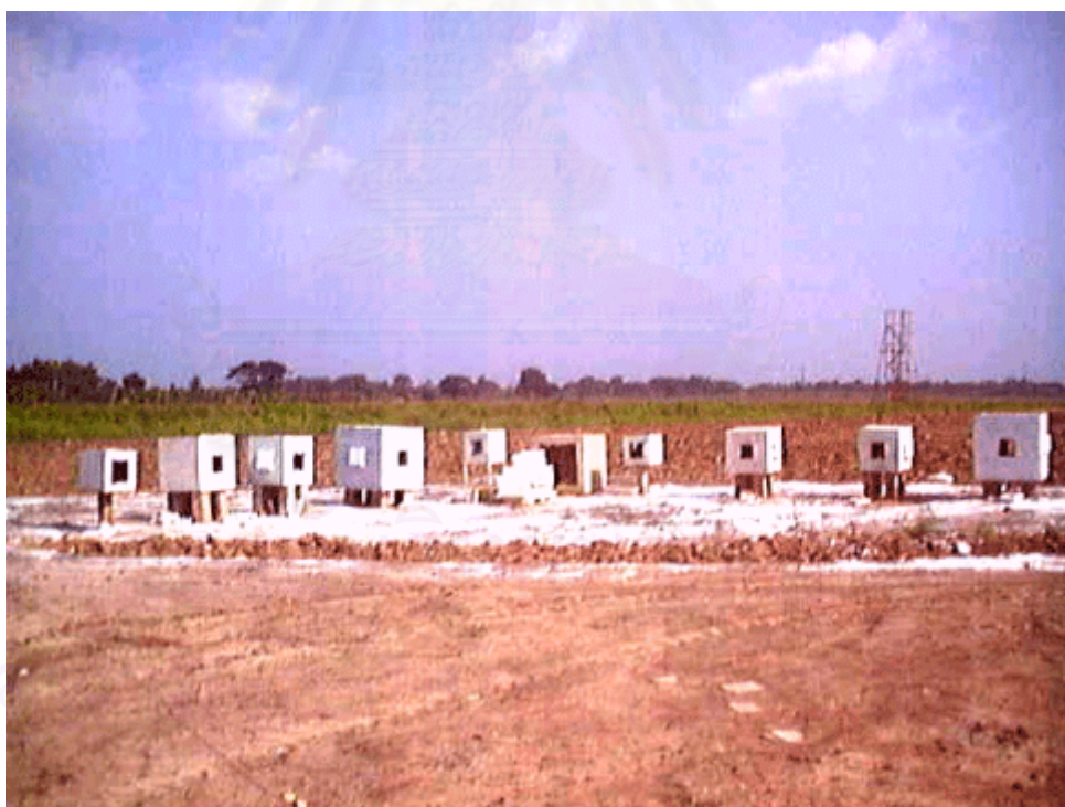
รูปที่ 4. 10 รูปแบบกล่องทดลองที่ใช้ทดสอบอิทธิพลของทิศทางการไหลเวียนอากาศธรรมชาติ
