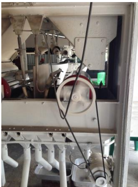
รูปที่ 3-26 เครื่องแยกแร่ไฟฟ้าแรงสูง (High-tension separator)
