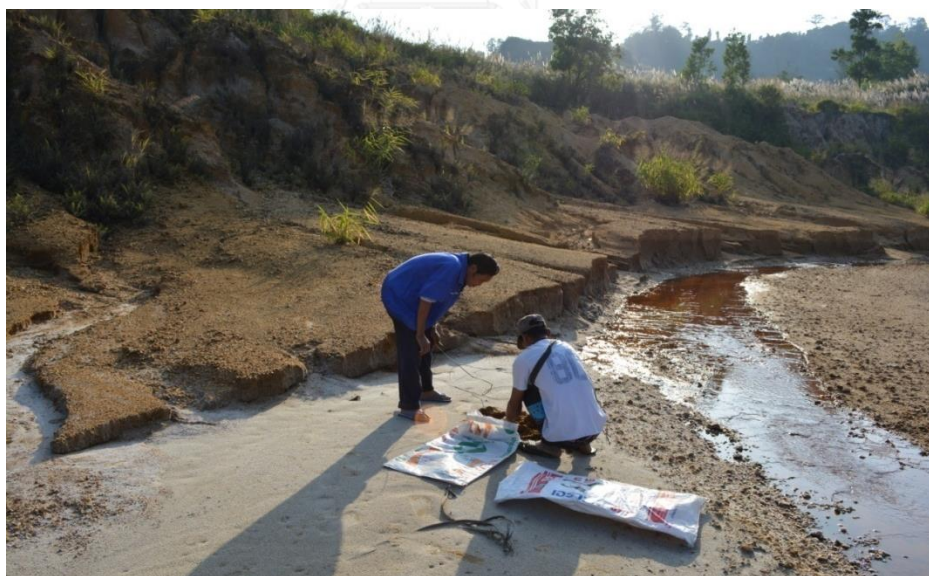
รูปที่ 3-1 เก็บตัวอย่างด้วยวิธีการแบบสุ่ม (Grab sampling) จากบ่อหางแร่
