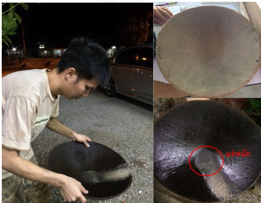
รูปที่ 3-4 การเลียจร้อนแร่ (Washing pan)
