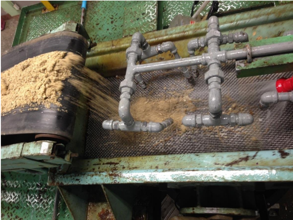
รูปที่ 3-23 เครื่องมือคัดขนาดแร่แบบเป็ยก (Vibrating screen) แบบ DAITO VIBRTING Eng.
