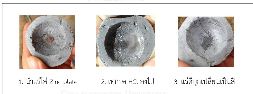
รูปที่ 3-14 การทดสอบแร่ดีบุกบน Zinc plate
