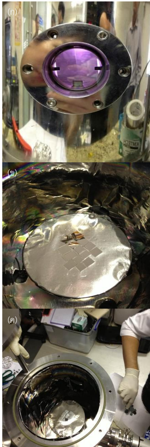
รูปที่ 3.4 (ก) เครื่องสปีดเทอริงโคตเตอร์ ขณะทำงาน (ข) หลังจากเคลือบด้วยนิกเกิลเสร็จแล้ว (ค) ห้องเคลือบและการเก็บชิ้นงานที่ถูกเคลือบด้วยนิกเกิลฟิล์ม
