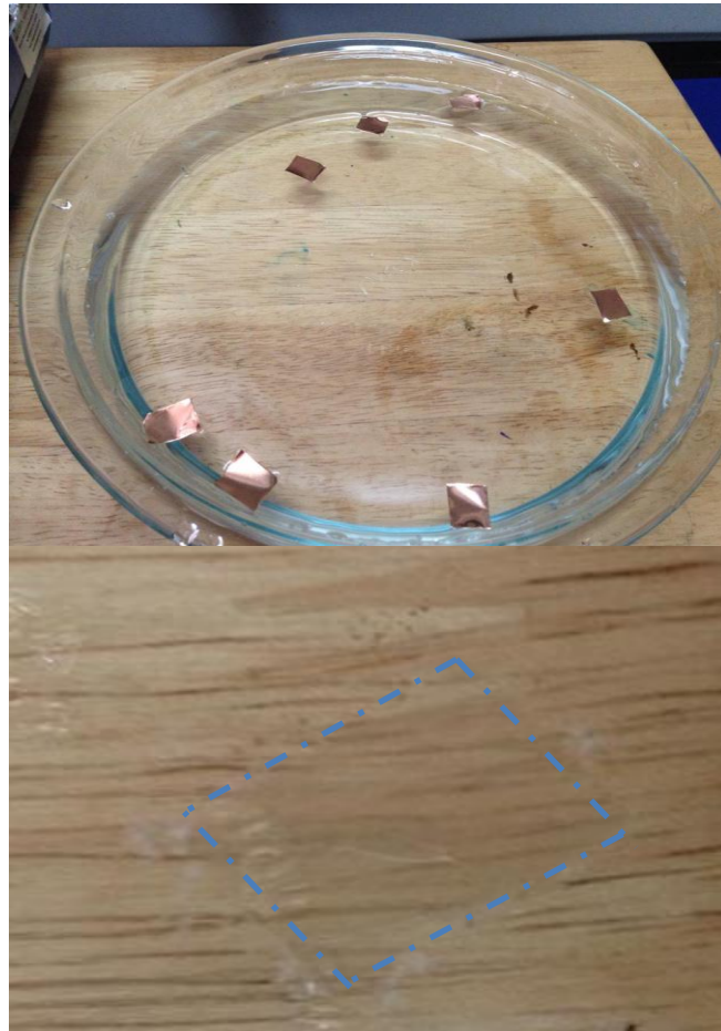
รูปที่ 4.4 ภาพก่อนการกัดคอปเปอร์ฟอยล์ (ภาพบน) หลังจากกัดคอปเปอร์ฟอยล์แล้ว (ภาพล่าง)
