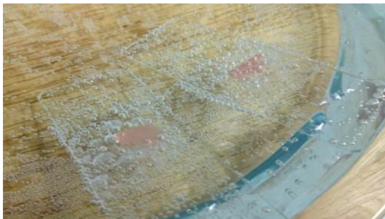
รูปที่ 4.15 การกักคอปเปอร์ฟอยล์บน PDMS ในสารละลายแอมโมเนียมเปอร์ซัลเฟต
