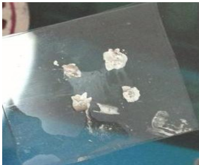
รูปที่ 4.17 กราฟีนที่ถูกถ่ายโอนลงบน PDMS และเติมซิลเวอร์เพสทั้ง 4 มุม
