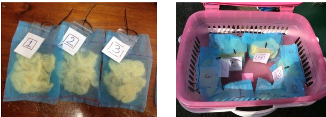
รูปที่ 3.6 ภาพซ้ายมือเส้นใยเอมีดอกซิมที่บรรจุอยู่ในถุงตาข่าย ภาพขวามือเส้นใยเอมีดอกซิมที่บรรจุอยู่ในถุงตาข่ายยึดติดกับตะกร้าพลาสติกหิ้วเพื่อจุ่มแช่ในทะเล
