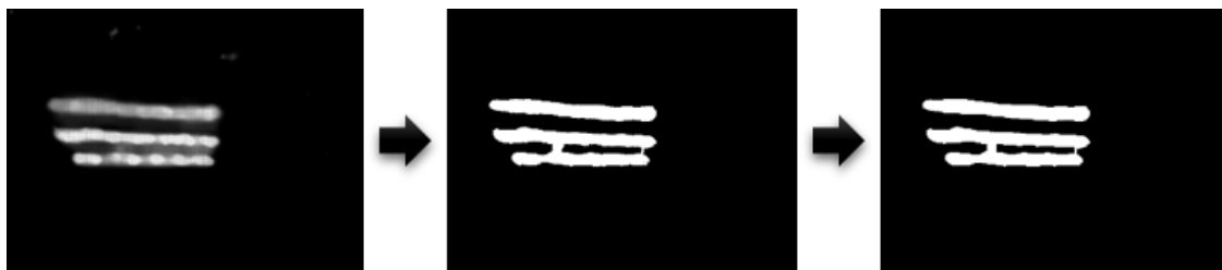
รูปที่ 3-13 ผลที่ได้จากการกระบวนกรกรองค่าขีดแบ่งและมอร์โฟโลยี บนแผนภาพความเชื่อมั่นของบริเวณที่มีข้อความ
