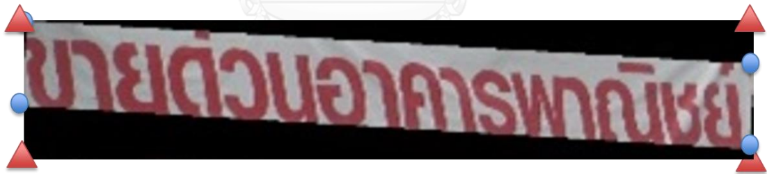
รูปที่ 3-23 พิกัดมุมที่ใช้ในขั้นตอนการแก้ไขการบิดเบี้ยวของภาพแบบเปอร์สเปคทีฟ
