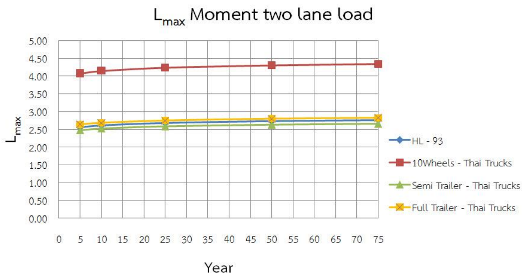
รูปที่ 4.46 ผลการวิเคราะห์ค่าเฉลี่ยน้ำหนักบรรทุกของโมเมนต์ดัดสำหรับสองช่องจราจรที่ช่วงความยาวสะพาน 22 เมตร
