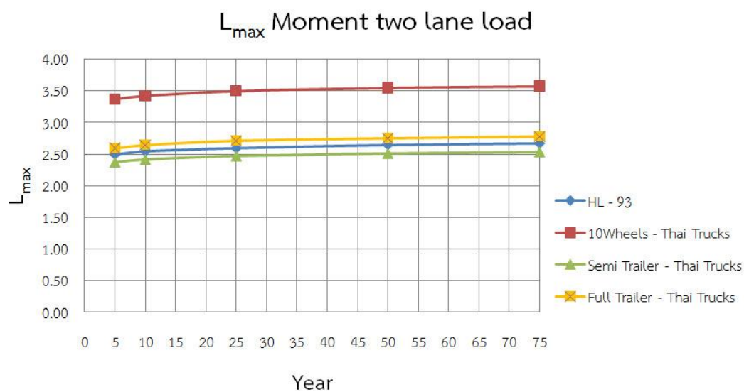
รูปที่ 4.42 ผลการวิเคราะห์ค่าเฉลี่ยน้ำหนักบรรทุกของโมเมนต์ตัดสำหรับสองช่องจราจรที่ช่วงความยาวสะพาน 20 เมตร
