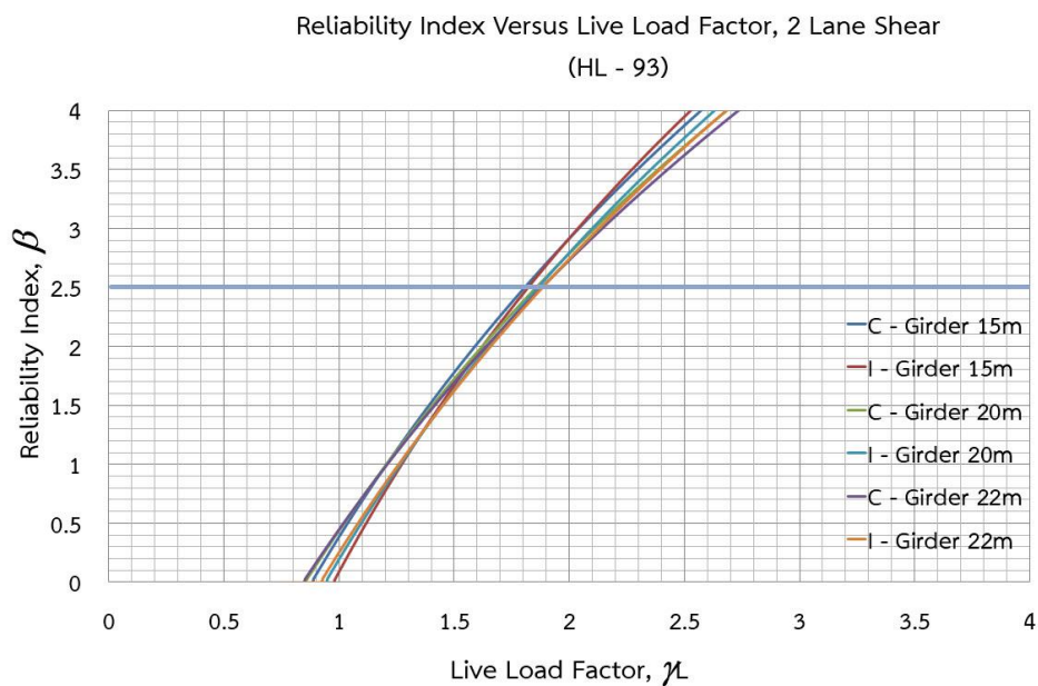
รูปที่ 5.32 ความสัมพันธ์ระหว่างค่าดัชนีความเชื่อมั่นและตัวคูณเพิ่มน้ำหนักบรรทุกของแรงเฉือนที่สองช่องจราจร (AASHTO HL - 93)
