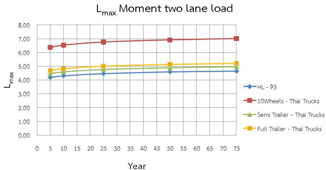
รูปที่ 4.28 ผลการวิเคราะห์ค่าเฉลี่ยน้ำหนักบรรทุกทุกจรของโมเมนต์ตัดสำหรับสองช่องจราจรที่ช่วงความยาวสะพาน 20 เมตร
