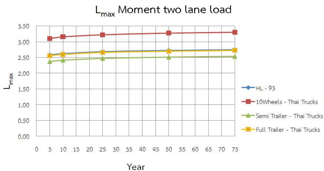
รูปที่ 4.38 ผลการวิเคราะห์ค่าเฉลี่ยน้ำหนักบรรทุกจรของโมเมนต์ดัดสำหรับสองช่องจราจรที่ช่วงความยาวสะพาน 15 เมตร
