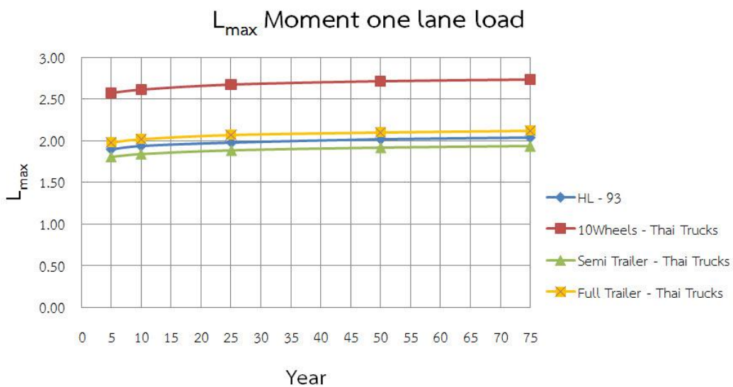
รูปที่ 4.40 ผลการวิเคราะห์ค่าเฉลี่ยน้ำหนักบรรทุกของโมเมนต์ดัดสำหรับหนึ่งช่องจราจรที่ช่วงความยาวสะพาน 20 เมตร
