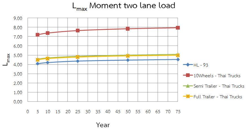
รูปที่ 4.32 ผลการวิเคราะห์ค่าเฉลี่ยน้ำหนักบรรทุกทุกจรของโมเมนต์ตัดสำหรับสองช่องจราจรที่ช่วงความยาวสะพาน 22 เมตร
