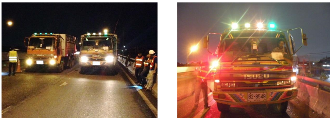
รูปที่ 3.19 การทดสอบปรับเทียบสะพานตาช้างด้วยรถบรรทุก 10 ล้อ
