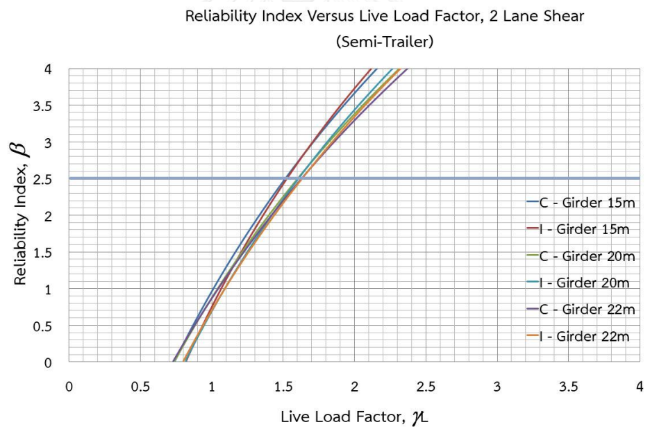
รูปที่ 5.24 ความสัมพันธ์ระหว่างค่าดัชนีความเชื่อมั่นและตัวคูณเพิ่มน้ำหนักบรรทุกของแรงเฉือนที่สองช่องจราจร (รถบรรทุกกึ่งพ่วง)
