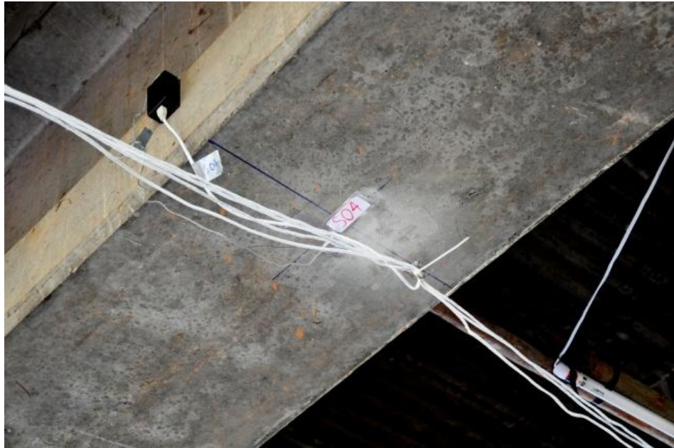
รูปที่ 3.11 ตำแหน่งการติดตั้งกล่องบริจคอมพลีทชั้น
