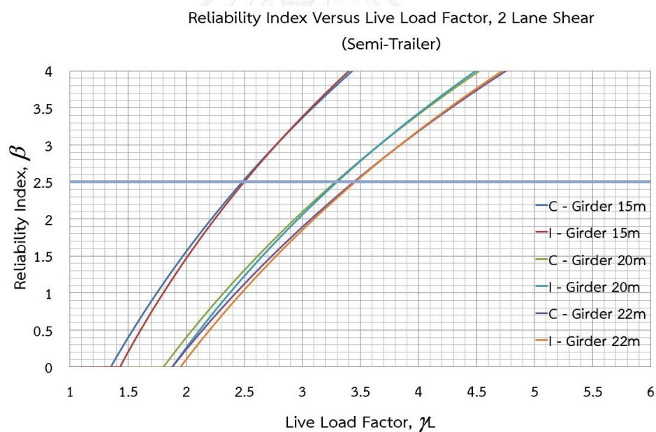
รูปที่ 5.8 ความสัมพันธ์ระหว่างค่าดัชนีความเชื่อมั่นและตัวคูณเพิ่มน้ำหนักบรรทุกจรของแรงเฉือนที่ สองช่องจราจร (รถบรรทุกกึ่งพ่วง)
