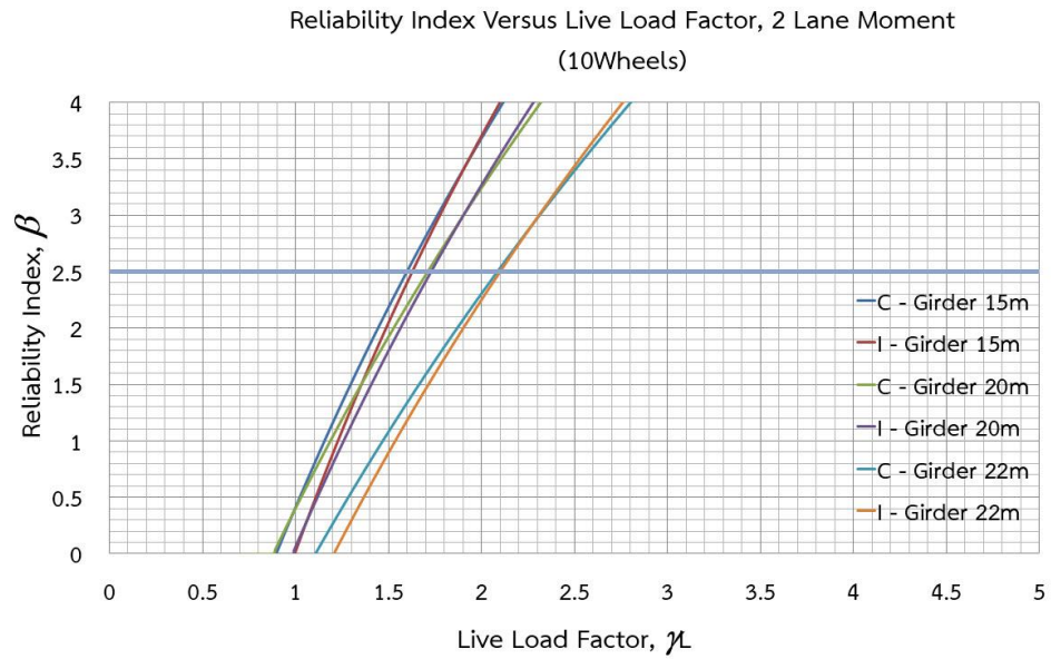
รูปที่ 5.19 ความสัมพันธ์ระหว่างค่าดัชนีความเชื่อมั่นและตัวคูณเพิ่มน้ำหนักบรรทุกจรของโมเมนต์ดัดที่สองช่องจราจร (รถบรรทุกสิบล้อ)
