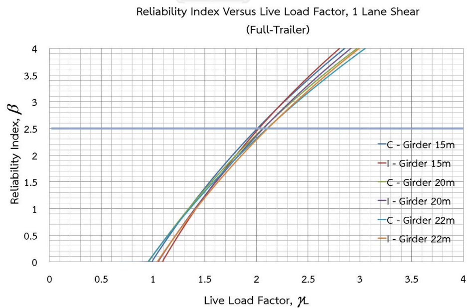
รูปที่ 5.26 ความสัมพันธ์ระหว่างค่าดัชนีความเชื่อมั่นและตัวคูณเพิ่มน้ำหนักบรรทุกจรของแรงเฉือนที่หนึ่งช่องจราจร (รถบรรทุกพ่วง)
