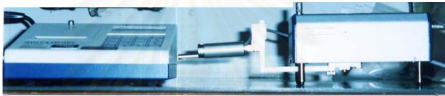
รูปที่ 3.3 แสดงลักษณะเครื่อง Surface roughness tester
