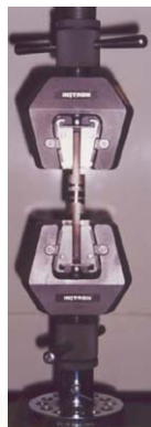
รูปที่ 3.8 แสดงลักษณะการทดสอบแรงดึงในการทดสอบความแข็งแรงในการยึดเกาะ
