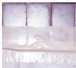
รูปที่ 3.9 ภาพแสดงชิ้นงานเตรียมนำไปเคลือบผิวทดสอบความทนทานของผิวเคลือบต่อการเปลี่ยนแปลงอุณหภูมิอย่างฉับพลัน
