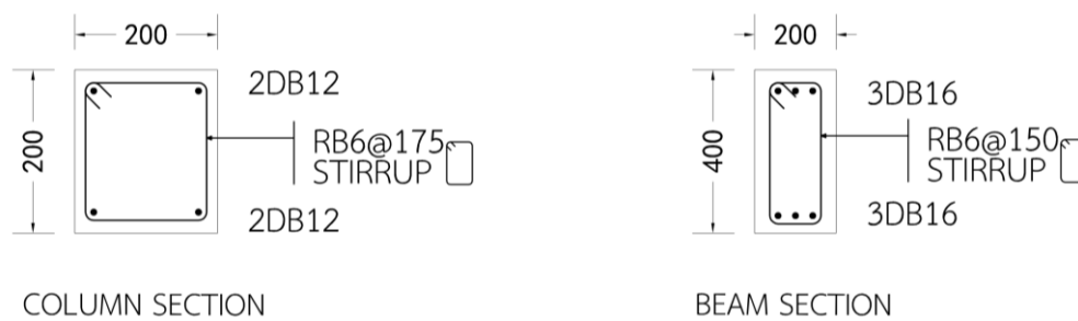
รูปที่ 4.5 รายละเอียดแบบหน้าตัดเสา C1 (ซ้าย) และคาน B1 (ขวา)
