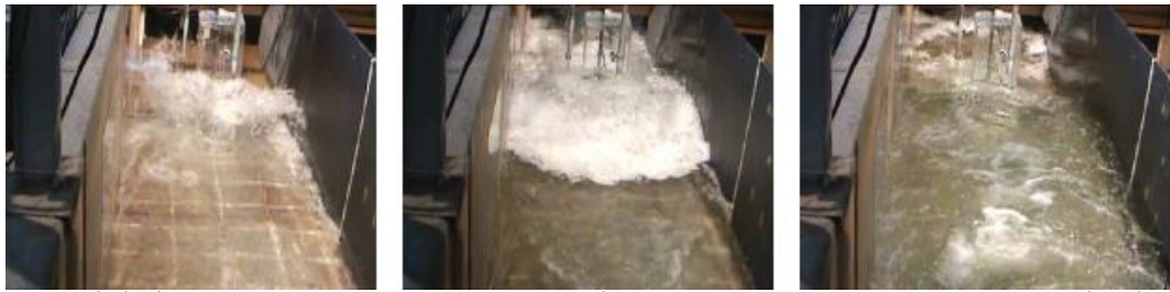
(ก) ช่วงที่คลื่นเริ่มเข้ากระทบกับโครงสร้าง (ข) ช่วงคลื่นไต่ระดับ (ค) ช่วงการไหลถอยกลับ
