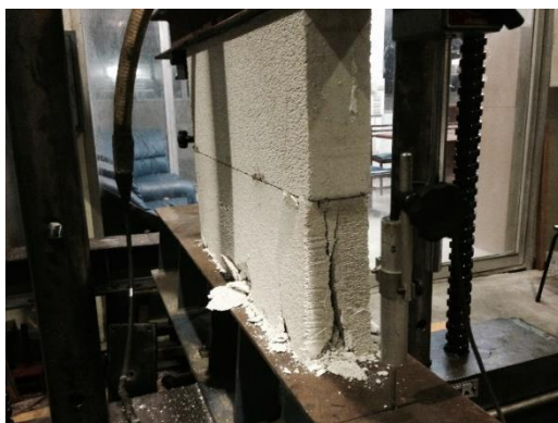
รูปที่ 3.9 การทดสอบเพื่อหาค่ากำลังกดของปริซึมอิฐก่อมวลเบา
