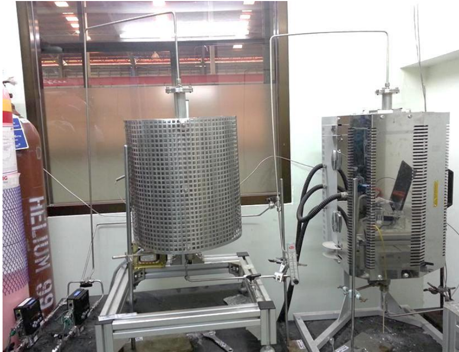
ภาพที่ 3.9 อุปกรณ์การทดสอบการดูดซับคาร์บอนไดออกไซด์และไฮโดรเจนซัลไฟด์แบบ 2 คอลัมน์ ต่ออนุกรมระบบขยาย 20 เท่า
