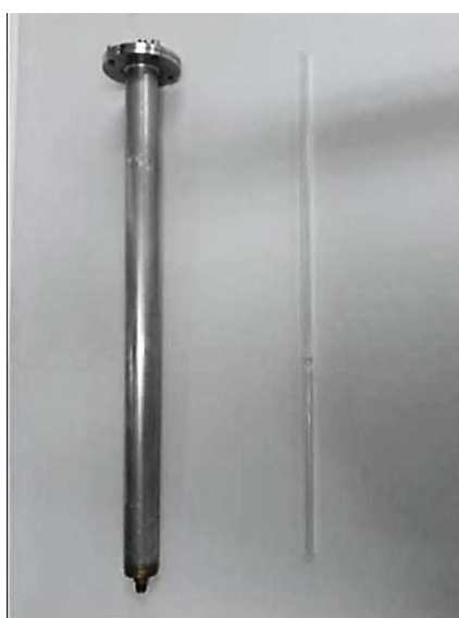
ภาพที่ 3.8 คอลัมน์ตัวดูดซับของระดับห้องปฏิบัติการกับระดับขยาย
