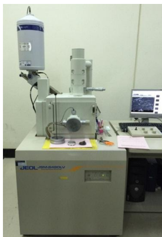
รูปที่ 3.12 กล้องจุลทรรศน์อิเล็กตรอนแบบส่องกราด ของ JEOL รุ่น JSM-6480LV
