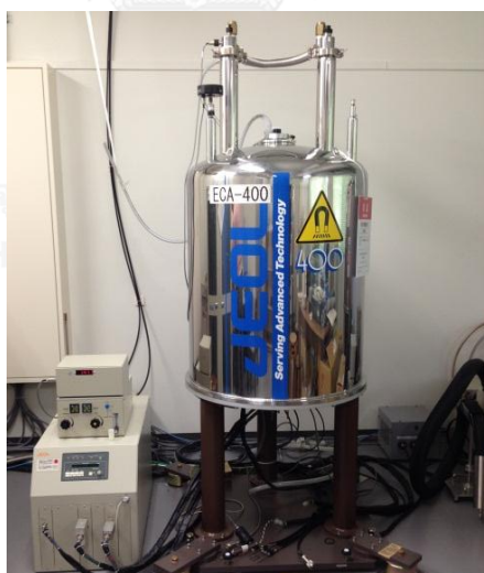
รูปที่ 3.6 เครื่องนิวเคลียร์แมกเนติกเรโซแนนซ์สเปกโตรมิเตอร์ของ JEOL รุ่น ECA-400
