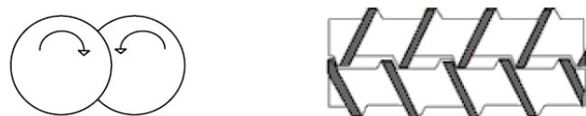
รูปที่ 2.16 สกรูคู่แบบหมุนสวนทางกัน (counter-rotating twin screw) [33]
