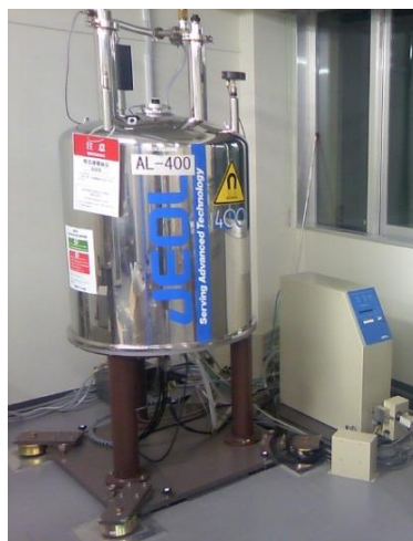
รูปที่ 3.5 เครื่องนิวเคลียร์แมกเนติกเรโซแนนซ์สเปกโตรมิเตอร์ของ JEOL รุ่น AL-400
