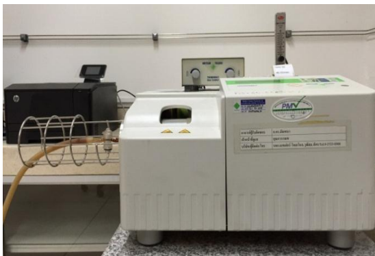
รูปที่ 3.14 เครื่องวิเคราะห์น้ำหนักภายใต้ความร้อนของ Mettler Toledo รุ่น TGA/SDTA851
