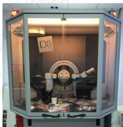
รูปที่ 3.13 เครื่องวิเคราะห์การเลี้ยวเบนรังสีเอกซ์ของ BRUKER AXS รุ่น Diffraktometer D8
