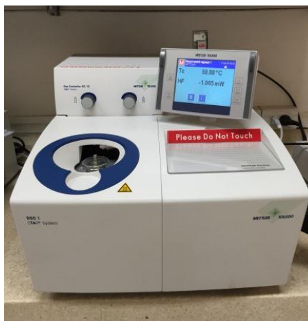
รูปที่ 3.16 เครื่องดีฟเฟอเรนเชียลสแกนนิ่งแคลอริมิเตอร์ของ Mettler Toledo รุ่น DSC 1 STAR ® System
