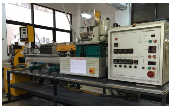
รูปที่ 3.3 เครื่องอัดรีดสกรูคู่ของ Thermo Prism รุ่น DSR-28
