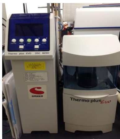
รูปที่ 3.15 เครื่องดิฟเฟอเรนเชียลสแกนนิ่งแคลอริมิเตอร์ของ Rigaku รุ่น Thermo plus EVO DSC 8230
