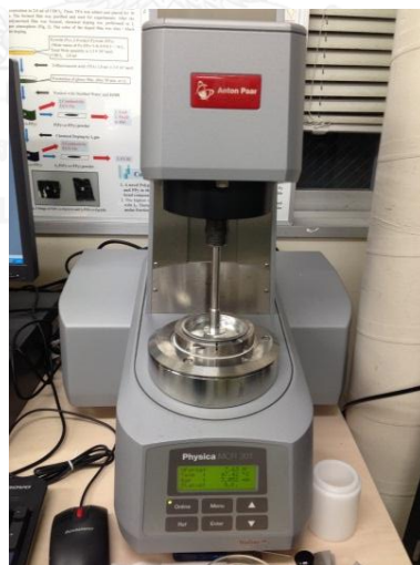
รูปที่ 3.17 เครื่องรีโอมิเตอร์ของ Anton Paar รุ่น Physica MCR 301
