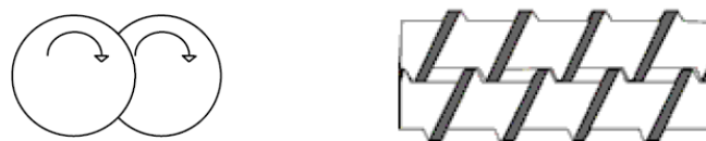
รูปที่ 2.15 สกรูคู่แบบหมุนทางเดียว (co-rotating twin screw) [33]
