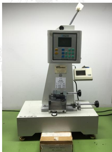
รูปที่ 3.11 เครื่องทดสอบความทนแรงกระแทก ของ GOTECH รุ่น GT-7045-MD
