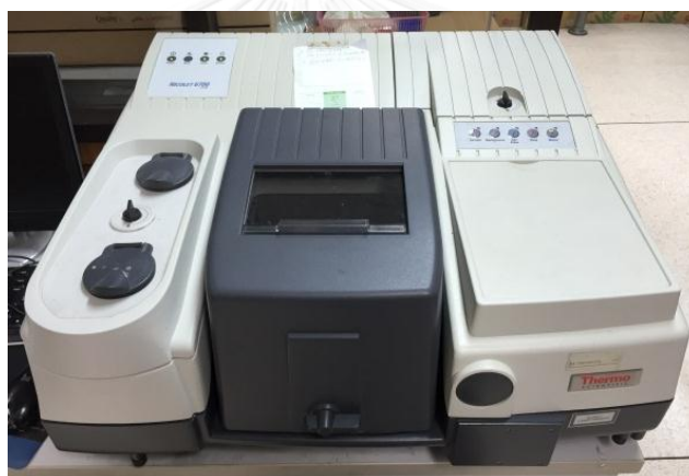
รูปที่ 3.4 เครื่องฟูเรียร์ทรานส์ฟอร์มอินฟราเรดสเปกโทรมิเตอร์ของ Thermo scientific รุ่น Nicolet 6700
