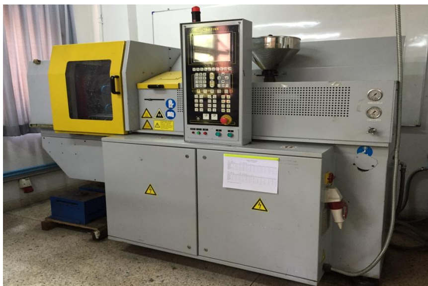
รูปที่ 3.7 เครื่องฉีดพลาสติกของ Topfine Precision Machinery รุ่น A25
