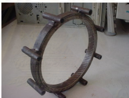
รูปที่ 4-1 โรเตอร์ของมอเตอร์พัดลมเพดานขนาดเส้นผ่านศูนย์กลาง 56 inches
