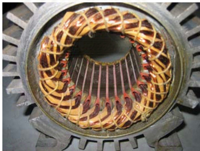
รูปที่ 4-8 มอเตอร์ 3 เฟส 8 Pole 24 สล็อต ต่อแบบ two parallel delta
