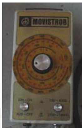
รูปที่ 4-12 แสดงเครื่องวัดความเร็วรอบแบบแสง
