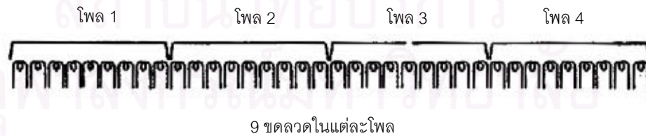
รูปที่ 2-51 จำนวนขดลวดในแต่ละโพลของมอเตอร์ 3 เฟส 36 ขดลวด 4 Pole [14]
