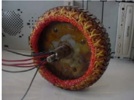
รูปที่ 4-2 สเตเตอร์ 3 เฟส 54 สลิต 18 Pole และพันขดลวดแบบแลป 2 ชั้น
