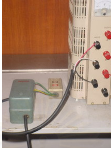
รูปที่ 4-10 แสดงการต่อสายไฟจากแหล่งจ่ายไฟ 380 V เข้ากับ Variable Voltage Transformer และ DOL Starter
