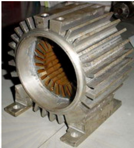
รูปที่ 4-7 แผ่นสเตเตอร์ที่อัดเข้ากับเรื่อนมอเตอร์
