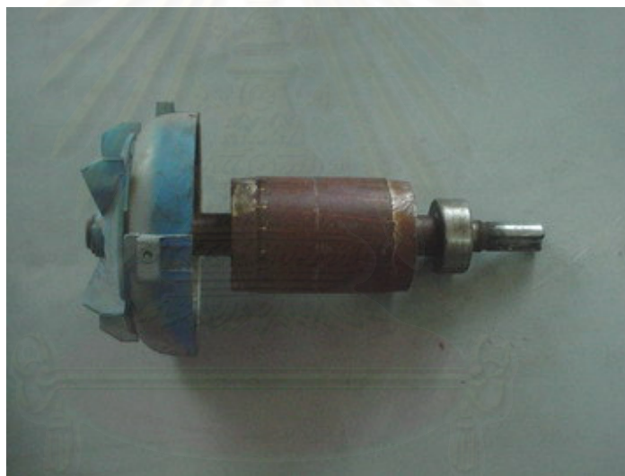
รูปที่ 4-4 โรเตอร์ของมอเตอร์ 3 เฟส 8 Pole ขนาด 0.5 hp
