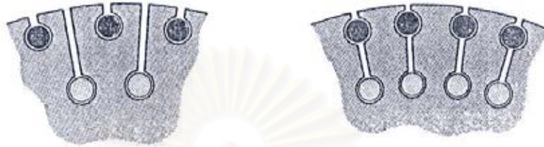
รูปที่ 2-35 รูปแบบการจัดเรียงตัวนำของโรเตอร์ชนิดกรงคู่ ซึ่งกรงชั้นนอกมีความต้านทานสูง (เช่น บรอนซ์) และกรงชั้นในมีความต้านทานต่ำ (เช่น ทองแดง) [7]
