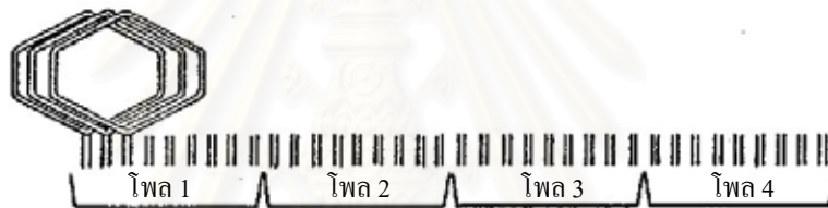
รูปที่ 2-53 แผนภาพอย่างง่ายของขดลวดในมอเตอร์ 3 เฟส 4 Pole [14]
