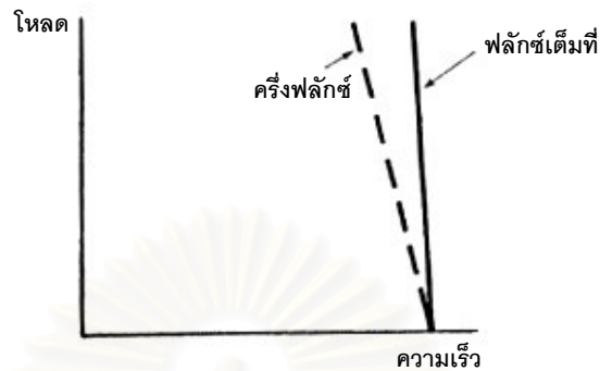
รูปที่ 2-15 ผลกระทบของฟลักซ์เกี่ยวกับความเร็วและโหลด [7]
