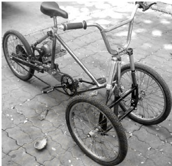
รูปที่ 6-2 แสดงการติดตั้งมอเตอร์กับจักรยาน 3 ล้อ
