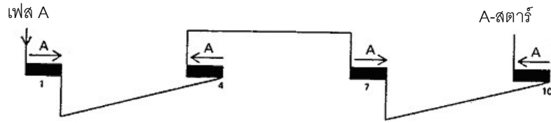
รูปที่ 2-61a แสดงการต่อหมุขดลวดของเฟส A เข้าด้วยกัน [14]
