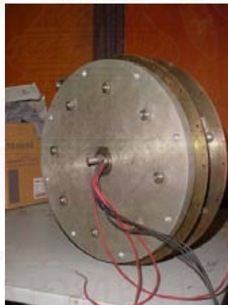
รูปที่ 4-3 มอเตอร์ 3 เฟส 18 Pole 54 สลิต ต่อแบบอนุกรมสตาร์
