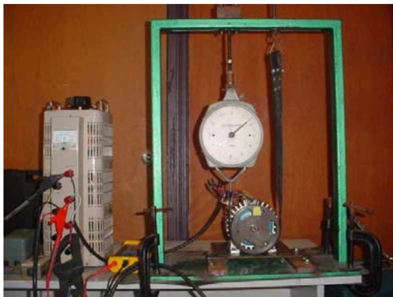
รูปที่ 4-14 แสดงการทดสอบแรงบิดของมอเตอร์แบบที่ 2
