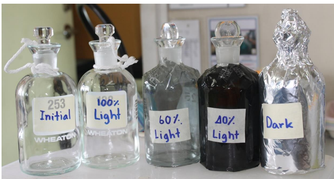
รูปที่ 3 - 2 ขวดในชุดการทดลองเพื่อหาค่าผลผลิตปฐมภูมิ
