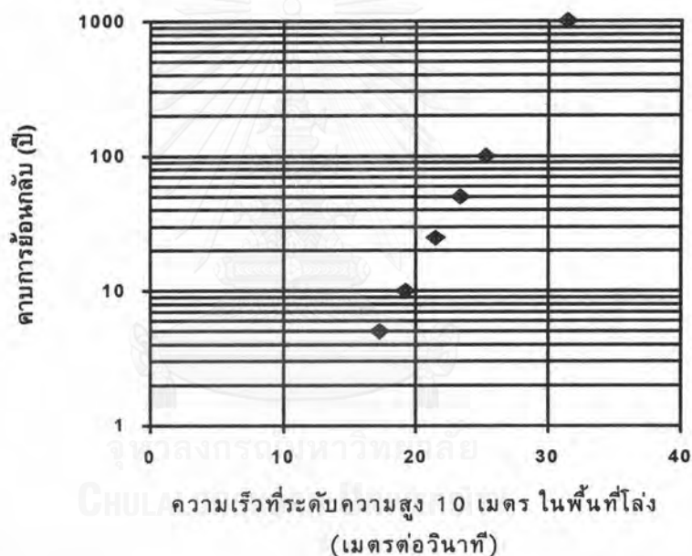
รูปที่ 2.3 ความสัมพันธ์ระหว่างความเร็วสูงสุดเฉลี่ยต่อชั่วโมงที่ความสูง 10 เมตร ในสภาพภูมิประเทศแบบที่โล่ง (Open Terrain) และคาบเวลาย้อนกลับของกรุงเทพมหานคร [2]
