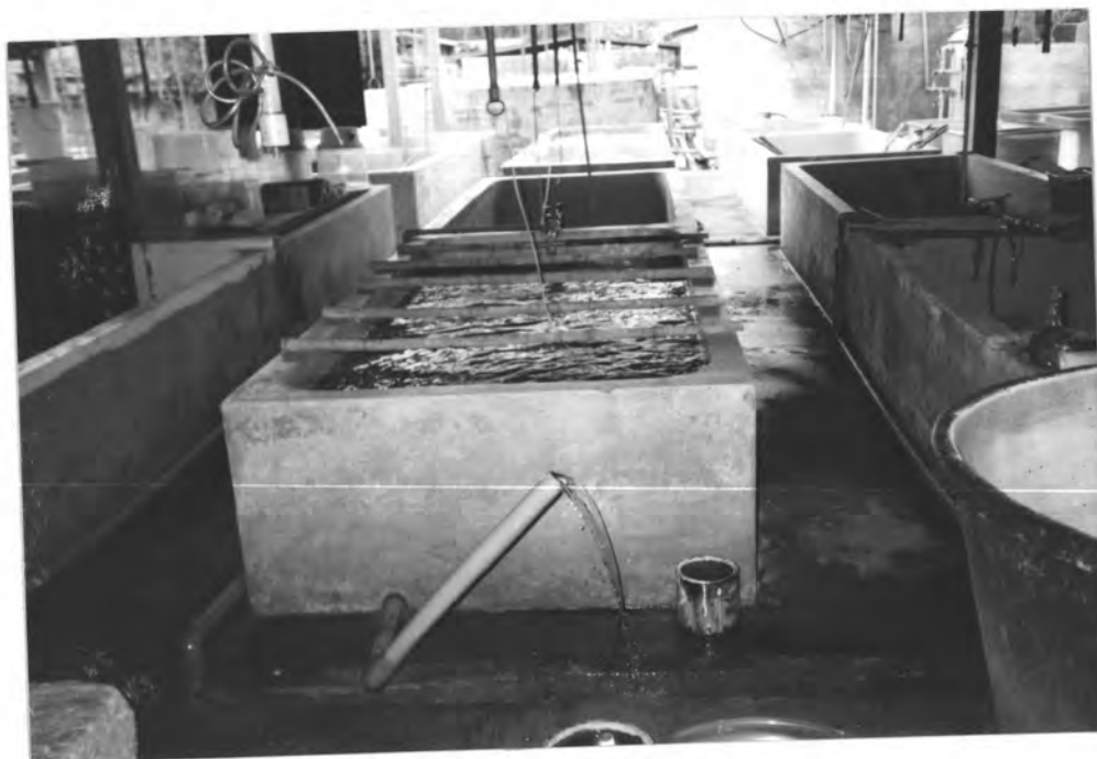
รูปที่ 10 การจัดการทดลองโดยใช้กระชังผูกเชือกกับไม้ไผ่ในบ่อขนาด 2.80x1.20x0.69 ลบ.ม. และระบบหมุนเวียนน้ำแบบ flow through
