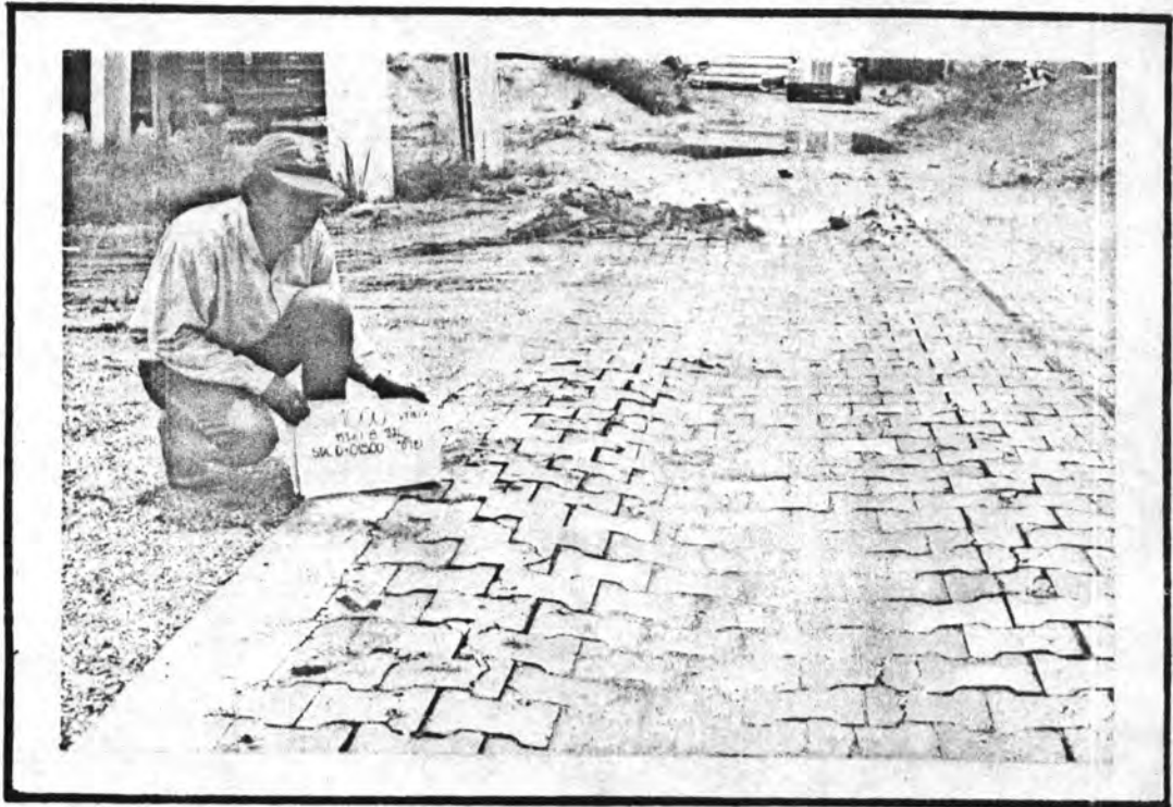
รูปที่ 4.25 การทรุดตัวของแผ่นคอนกรีตบล็อกหนา 8 ซม. (ร่องล้อด้านซ้าย) ที่ 1,000 เทีย
