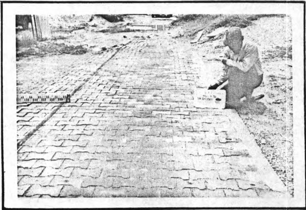
รูปที่ 4.23 การทรุดตัวของแผ่นคอนกรีตบล็อกหนา 8 ซม. เมื่อให้รถวิ่งผ่าน 1,000 เที่ยว
