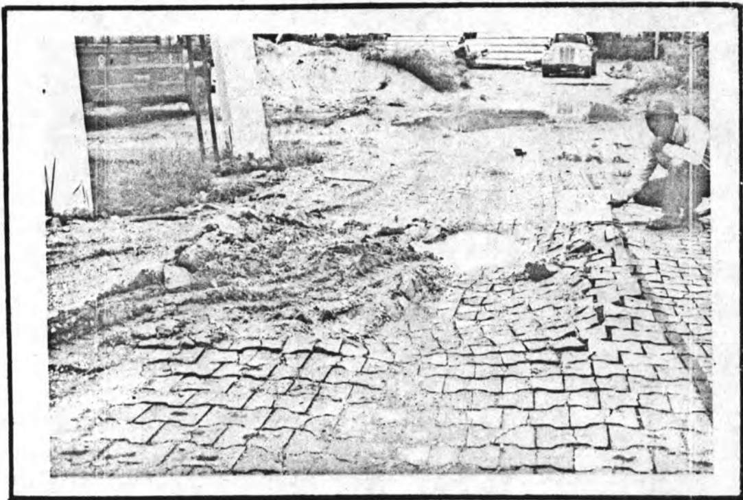
รูปที่ 4.24 การทรุดตัวของแผ่นคอนกรีตบล็อกหนา 5 ซม. เมื่อให้รถวิ่งผ่าน 1,000 เที่ยว
