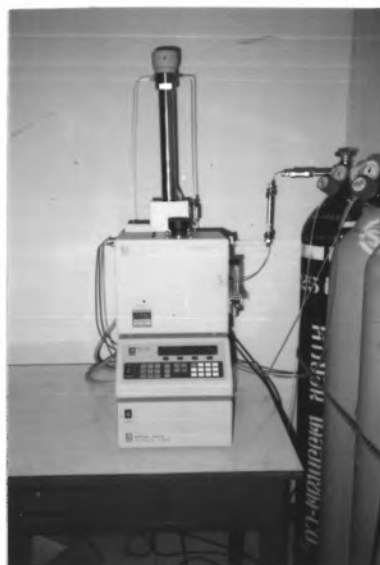
รูปที่ 3.2 เครื่องสักระยะในสภาพของไหลเหนือจุดวิกฤต
