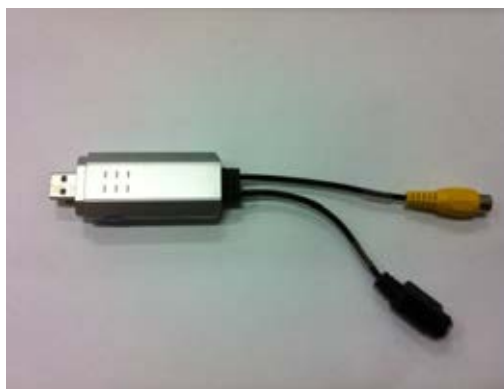
รูปที่ ก.7 อุปกรณ์บันทึกสัญญาณวีดีโอแบบต่อภายนอก
