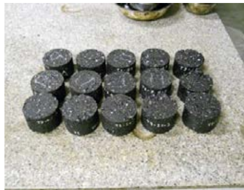
ภาพที่ 4.2 (ซ้าย) เครื่องบดอัดอัตโนมัติแบบ Marshall (ขวา) ตัวอย่างสำหรับการทดสอบ Marshall Stability และ Flow
