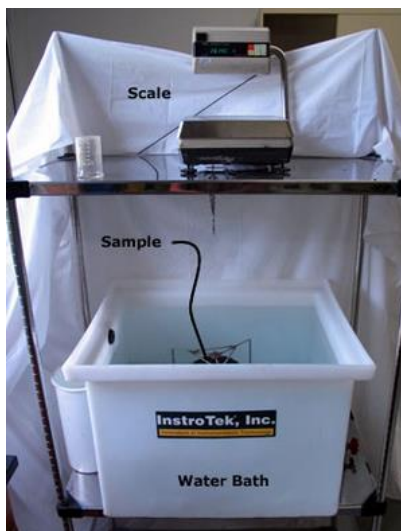
ภาพที่ 2.23 ชุดอุปกรณ์วัดน้ำหนักสำหรับการทดสอบหาค่า Bulk Specific Gravity (Pavement Interactive,2012: Online)
