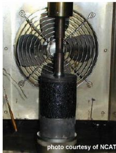
ภาพที่ 2.7 การทดสอบ Unconfined Static Creep (Pavement Interactive,2012: Online)
