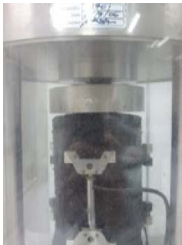
ภาพที่ 3.4 ตัวอย่างที่ส่วนหัวไม่เรียบขณะทำการทดสอบ Dynamic Modulus
