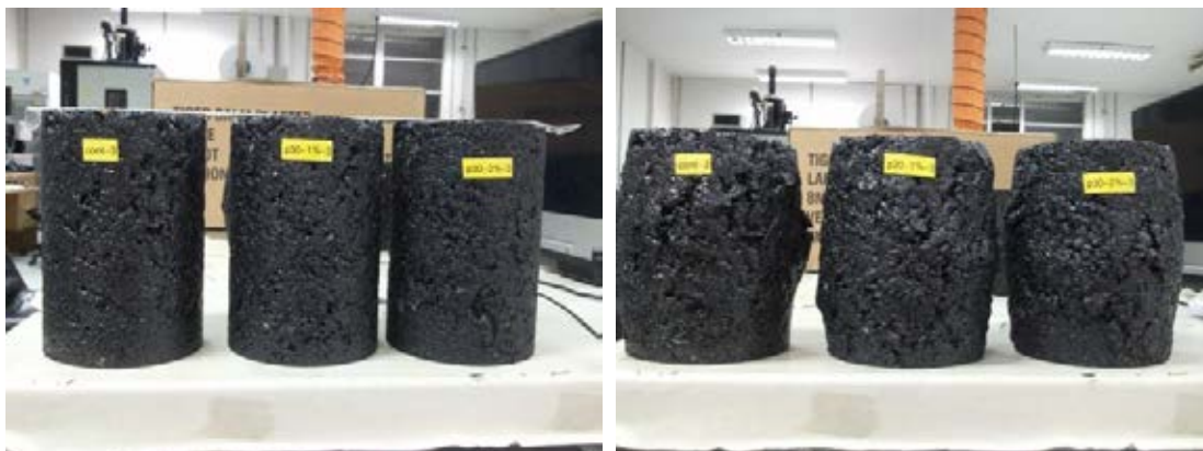
ภาพที่ 4.13 ตัวอย่างที่มีขนาดคละแบบ Dense รูปแบบส่วนผสมที่ไม่มียางบด, ผสมยางบดขนาด #16 2% และผสมยางบดขนาดผ่าน #30 2% เรียงลำดับจากซ้ายไปขวา (ซ้าย) ก่อนการทดสอบ (ขวา) หลังจากทดสอบ
