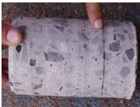
ภาพที่ 3.1 ผิวด้านข้างตัวอย่างที่ไม่เรียบจากการเจาะแกนกลางตัวอย่าง
