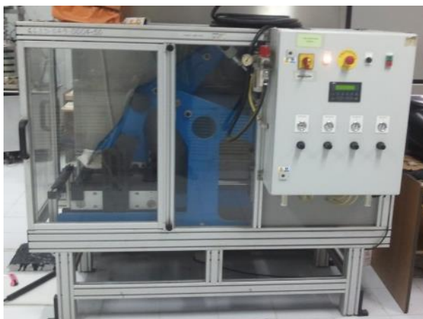
ภาพที่ 4.18 เครื่องบดอัดวัสดุแบบ Roller Compactor สำนักวิจัยและพัฒนางานทาง กรมทางหลวง
