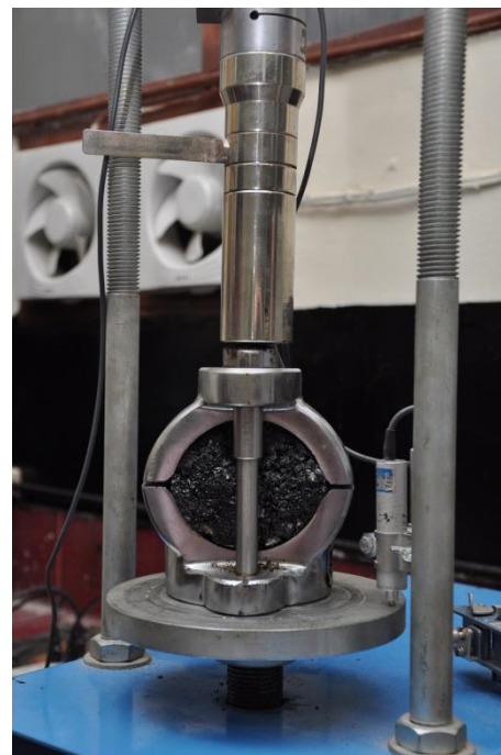
ภาพที่ 4.3 การทดสอบ Marshall Stability & Flow ของวัสดุแอสฟัลต์คอนกรีต (ซ้าย) ก่อนการทดสอบ (ขวา) หลังการทดสอบ
