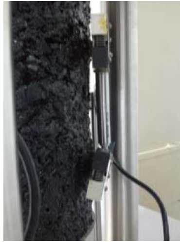
ภาพที่ 3.2 LVDT ไม่สามารถวัดค่าได้เนื่องจากอุปกรณ์ยึดหลุด
