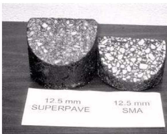
ภาพที่ 2.29 ความแตกต่างของโครงสร้างมวลรวม ระหว่าง SMA และแอสฟัลต์คอนกรีตแบบ Dense Graded (Pavement Interactive,2012: Online)
