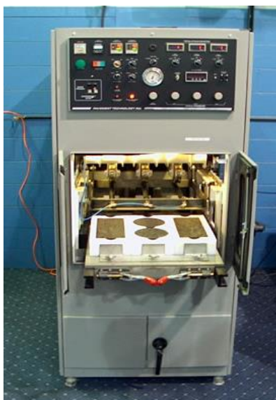
ภาพที่ 2.14 เครื่องมือ Asphalt Pavement Analyzer (APA) (Pavement Interactive,2012: Online)
