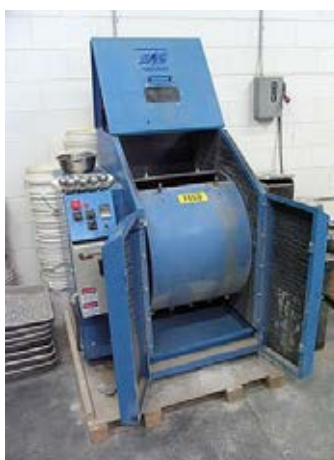
ภาพที่ 2.18 เครื่องมือทดสอบ Los Angeles Abrasion (Pavement Interactive,2012: Online)
