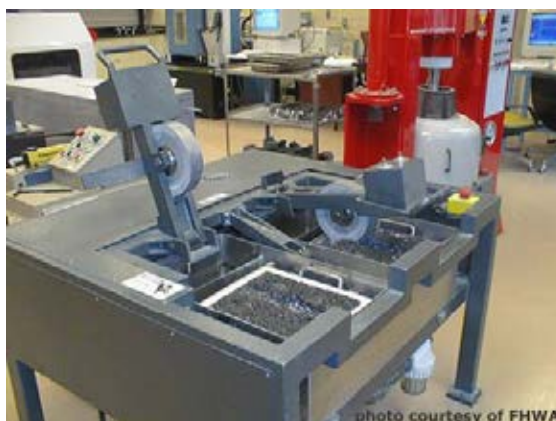
ภาพที่ 2.16 เครื่องมือ Hamburg Wheel Tracking Device (HWTD) (Pavement Interactive,2012: Online)
