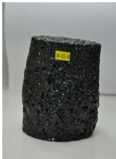
ภาพที่ 4.16 การวิบัติของตัวอย่างที่ไม่ได้ระนาบจากการทดสอบ Dynamic Creep
