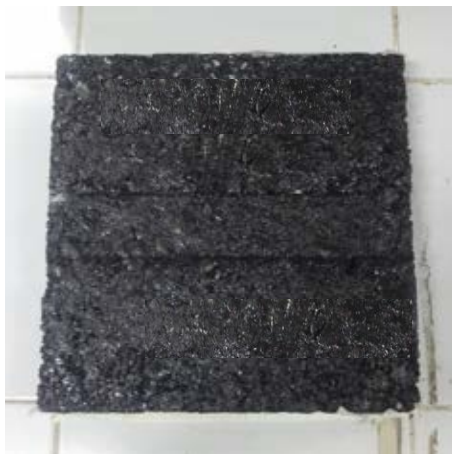
ภาพที่ 4.20 ตัวอย่างแบบแผ่น หลังจากการทดสอบด้วยเครื่อง Wheel Tracking
