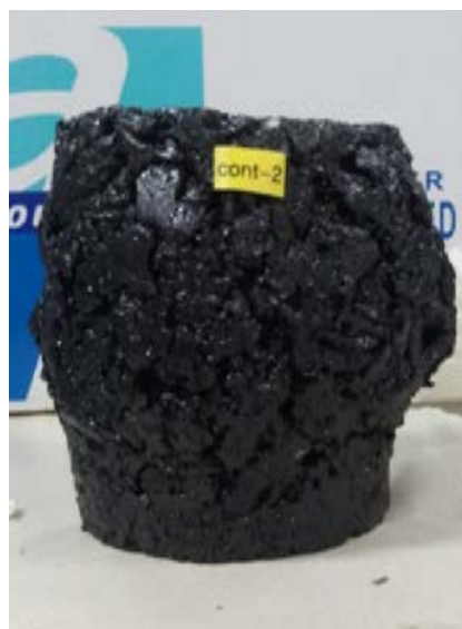
ภาพที่ 4.17 การวิบัติจากความหนาแน่นที่ไม่สม่ำเสมอของตัวอย่าง
