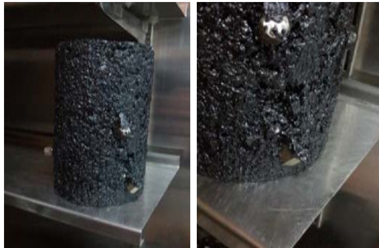
ภาพที่ 3.3 อุปกรณ์ยึดจับ LVDT หลุด จากเนื้อวัสดุที่หลุดออกจากชั้นตัวอย่าง
