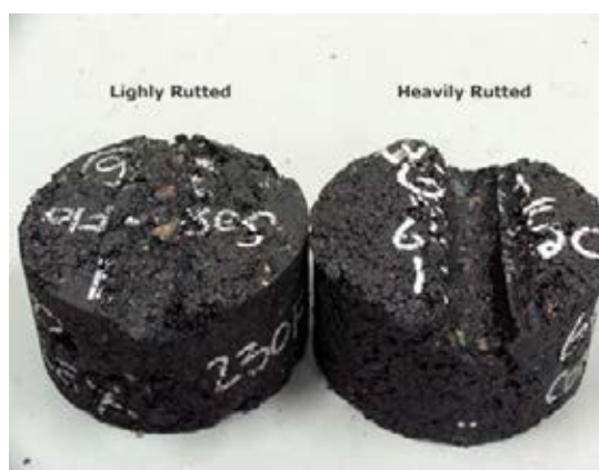
ภาพที่ 2.15 ตัวอย่างภายหลังการทดสอบด้วยเครื่องมือ APA (Pavement Interactive,2012: Online)
