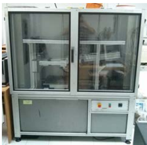
ภาพที่ 4.19 เครื่องทดสอบ Wheel Tracking สำนักวิจัยและพัฒนางานทาง กรมทางหลวง
