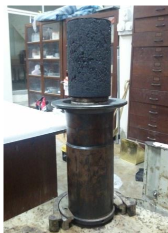
ภาพที่ 4.7 (ซ้าย) Gyratory Compactor (ขวา) ตัวอย่างสำหรับการทดสอบ Dynamic Creep
