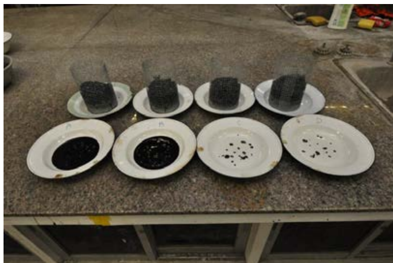
ภาพที่ 4.5 ตัวอย่างหลังการทดสอบ Draindown ของงาน A, B, C และ D เรียงจากซ้ายไปขวาตามลำดับ
