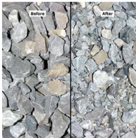
ภาพที่ 2.19 ลักษณะของมวลรวม ก่อนและหลังการทดสอบ LA Abrasion (Pavement Interactive,2012: Online)
