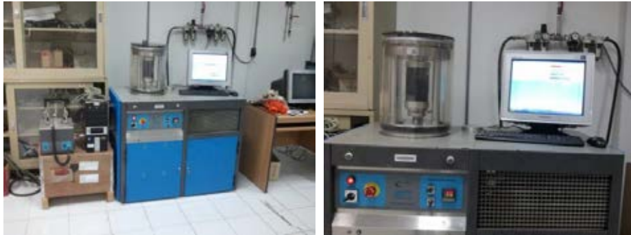
ภาพที่ 4.11 (ซ้าย) เครื่อง AMPT (ขวา) ตัวอย่างในเครื่อง AMPT ที่พร้อมทดสอบ Flow Number
