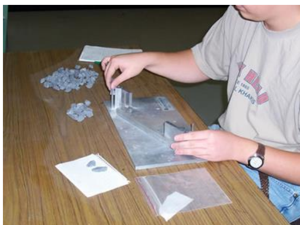
ภาพที่ 2.21 การทดสอบ Flat and Elongated (Pavement Interactive,2012: Online)
