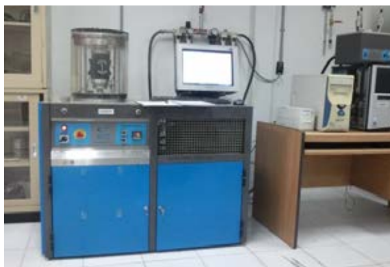
ภาพที่ 2.12 เครื่องมือ Asphalt Mixture Performance Tester (AMPT) สำนักวิจัยและพัฒนาทาง กรมทางหลวง
