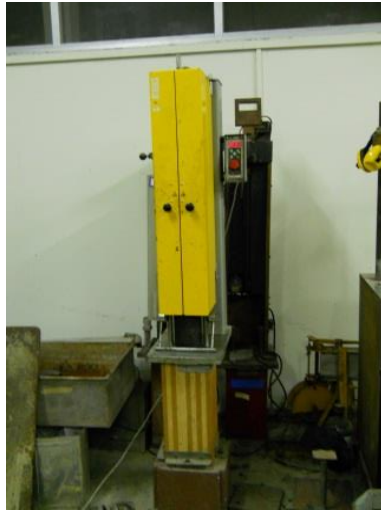
ภาพที่ 4.2 (ซ้าย) เครื่องบดอัดอัตโนมัติแบบ Marshall (ขวา) ตัวอย่างสำหรับการทดสอบ Marshall Stability และ Flow
