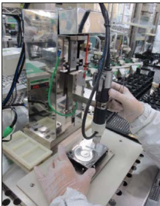
รูปที่ 3.4 ขั้นตอนการขันสกรู Pivot Top cover
