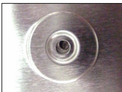
รูปที่ 4.10 รูสกรู Pivot บน Top cover เยื้องกับรูสกรู Pivot
