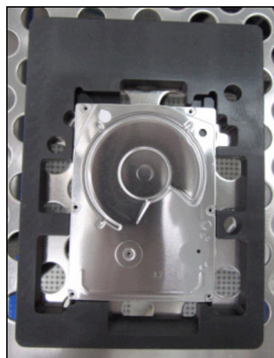
รูปที่ 6.3 Fixture สำหรับชั้นสกรู Top cover ด้วยเครื่องจักร
