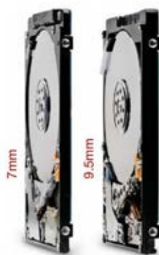
รูปที่ 1.2 ฮาร์ดดิสก์ไดร์ฟขนาด 2.5 นิ้ว หนา 7.0 และ 9.5 มิลลิเมตร
