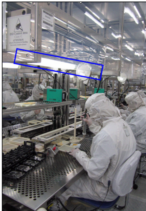
รูปที่ 6.14 ตำแหน่งของโคมไฟส่องสว่างที่มีค่าความเข้มแสง 700 ลักซ์
