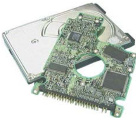
รูปที่ 1.6 แผงวงจรไฟฟ้าและฮาร์ดดิสก์
