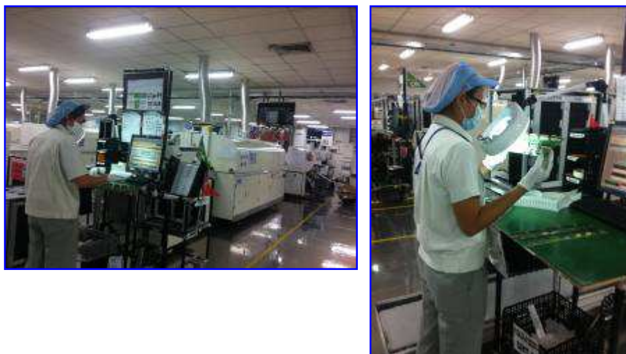
รูปที่ 1.4 การตรวจสอบด้วยสายตาในสายการผลิต
