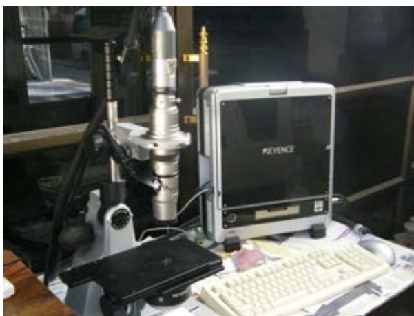
รูปที่ 3.8 ไมโครสโคปสำหรับวัดขนาดความลึกหรือ
