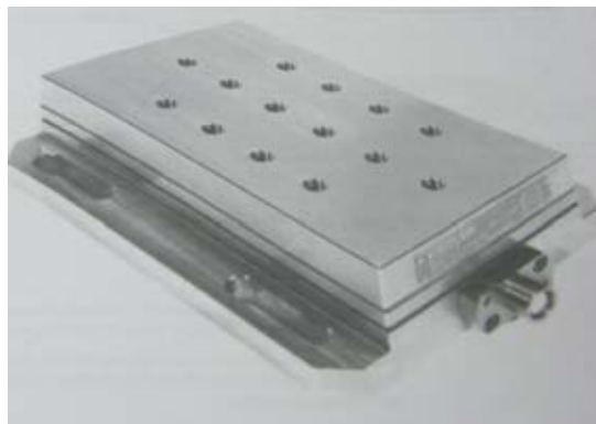
รูปที่ 3.5 ไดนาโมมิเตอร์สำหรับวัดแรงตัด
