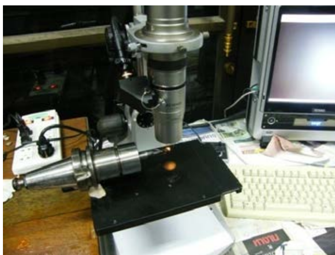
รูปที่ 3.14 การวัดขนาดความลึกหอรของมีดกัด
