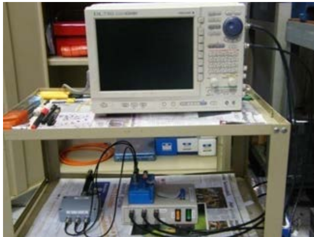
รูปที่ 3.12 การเชื่อมต่อสายไดนาโมวัดแรงเข้ากับเครื่องขยายสัญญาณและเครื่องออสซิลโลสโคป
