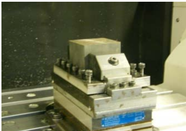
รูปที่ 3.13 การเตรียมชิ้นงานและชิ้นงานที่ผ่านการปาดหน้าเรียบร้อยแล้ว
