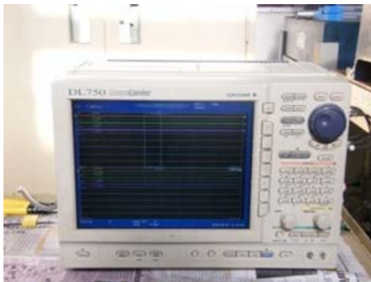
รูปที่ 3.7 ออสซิลโลสโคปสำหรับแสดงผลและบันทึกค่าแรงตัด
