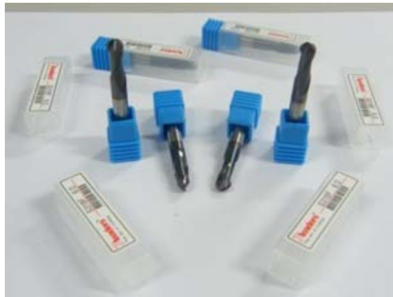
รูปที่ 3.3 มีดกัดแบบหัวบอล ยี่ห้อ 7-Leaders
