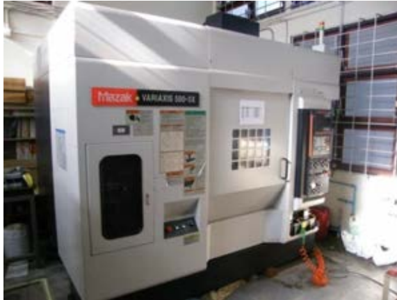
รูปที่ 3.4 เครื่องซีเอ็นซีแมชชีนนิ่งเซ็นเตอร์ชนิด 5 แกน
