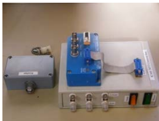
รูปที่ 3.6 ชาร์จแอมพลิไฟเออร์สำหรับขยายสัญญาณแรงตัด
