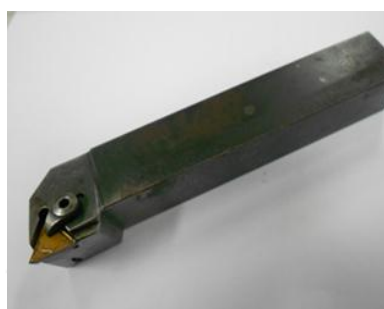
รูปที่ 3.2 ด้ามมีดกลึง ยี่ห้อ Kyocera เบอร์ CTGPR 2525M-16N
