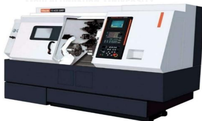
รูปที่ 3.4 เครื่องกลึงซีเอ็นซี ชนิด 4 แกน
