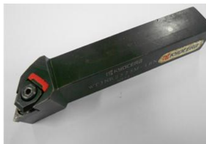
รูปที่ 3.2 ด้ามมีดกลึง ยี่ห้อ Kyocera เบอร์ CTGPR 2525M-16N
