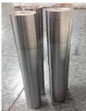
รูปที่ 3.1 ชิ้นงานที่ใช้กลึงตัดในการทดลอง
