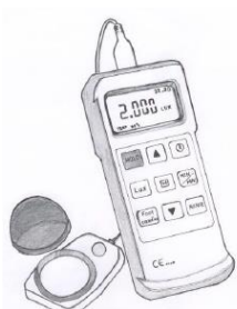
รูปที่ 12 แสดงรูปเครื่องมือวัดแสง (Lux-Meter) รุ่น LX-101
