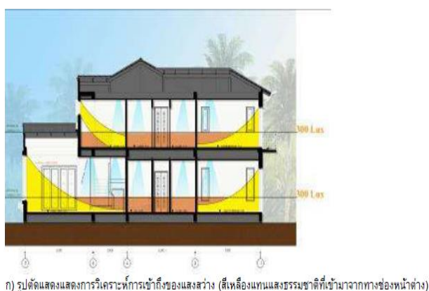
รูปที่ 15 แสดงรูปตัดการวิเคราะห์ช่องเปิดเพื่อนำแสงธรรมชาติเข้ามาสู่อาคาร
