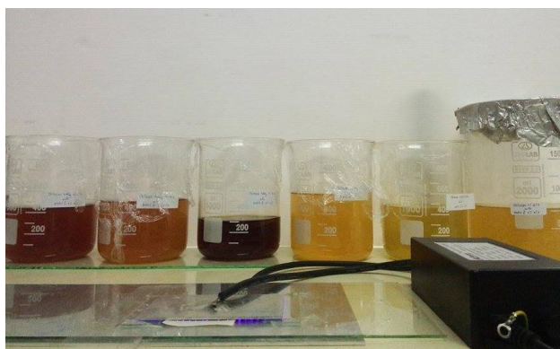
รูปที่ 16 การตัดแปรผ้าไหมด้วยพลาสมาและสารละลายไคโตซาน
