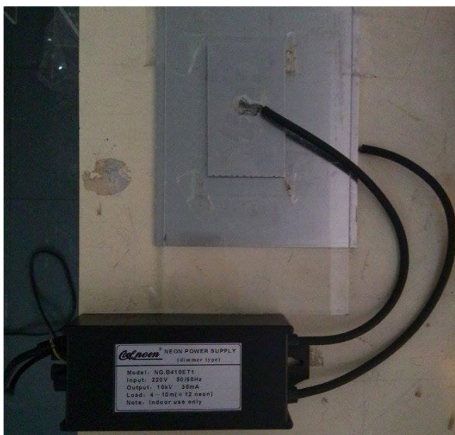
รูปที่ 14 เครื่องให้กำเนิดพลาสมาสำหรับงานวิจัย
