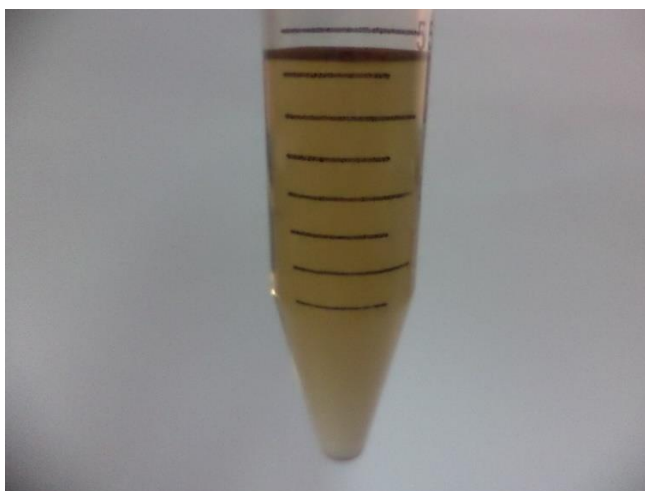
รูปที่ 4.2 กราฟีนออกไซด์ภายหลังการทำความสะอาด (wash) และฉีดผ่านตัวกรอง PVDF
