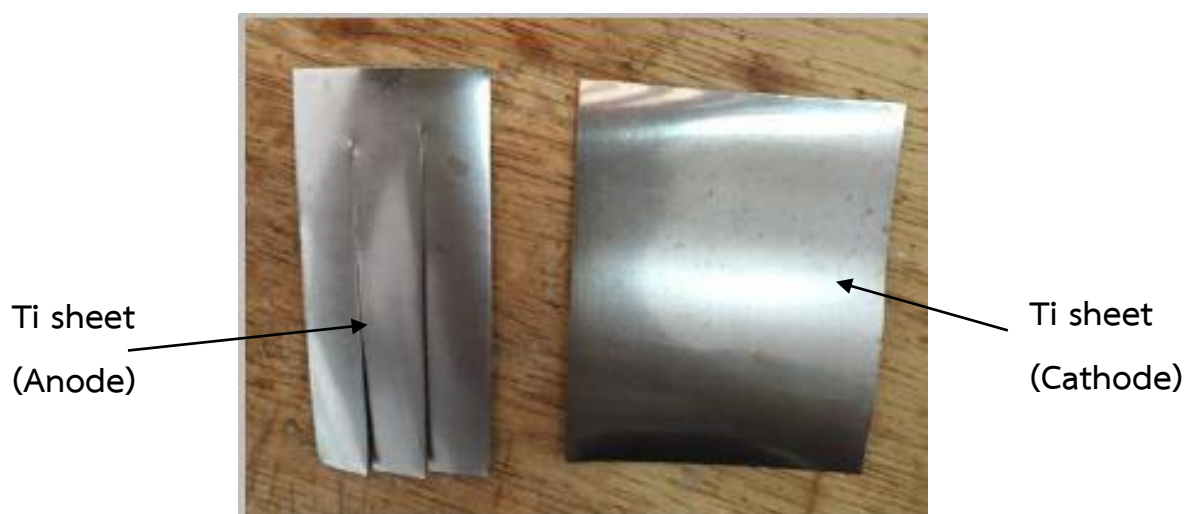
รูปที่ 3.2 ไทเทเนียมที่ใช้เป็นขั้วแอโนด (ซ้าย) และแคโทด (ขวา)
