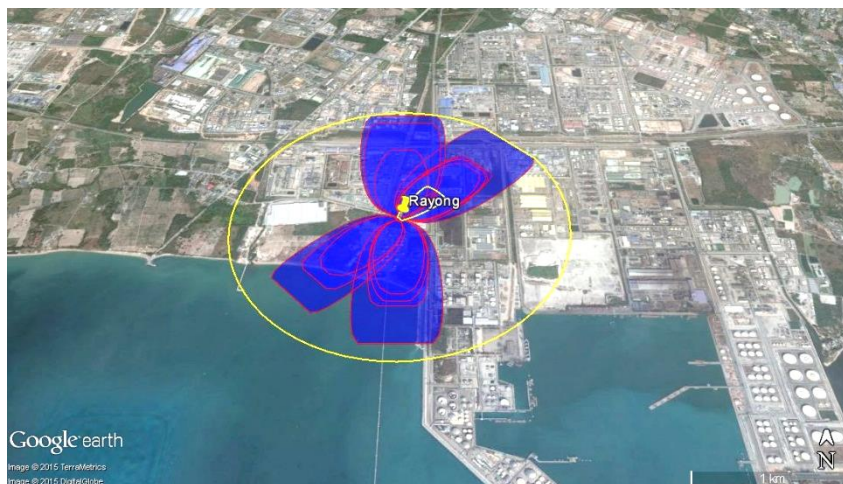
รูปที่ 6.11 ลักษณะพื้นที่กั้นชนของโรงงานที่มีสารอะคริไลไนไตรท์ ในนิคมอุตสาหกรรมจังหวัดจังหวัดระยอง
