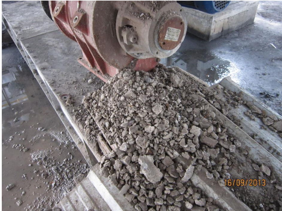
รูปที่ 18 Clinker ที่เกิดจากการหลอมตัวของเชื้อเพลิงสาเหตุเกิดจากการกระจายตัวของเชื้อเพลิงไม่ดีพอ ในบางบริเวณมีการเผาไหม้ที่รุนแรงบางบริเวณมีการเย็นตัวลงสลับกัน
