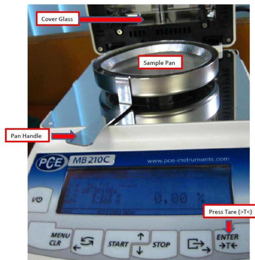
รูปที่ 26 การเซตค่าศูนย์ของอุปกรณ์วิเคราะห์ค่าความชื้น
