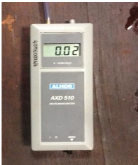
รูปที่ ซ-2 เครื่องมือวัดความดันยี่ห้อ Alnor รุ่น AXD 510
