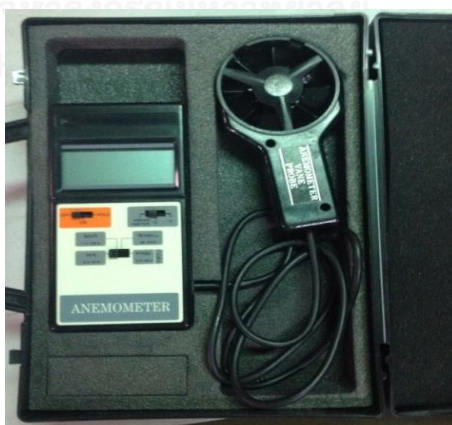
รูปที่ ซ-3 เครื่องวัดความเร็วลม (Anemometer)
