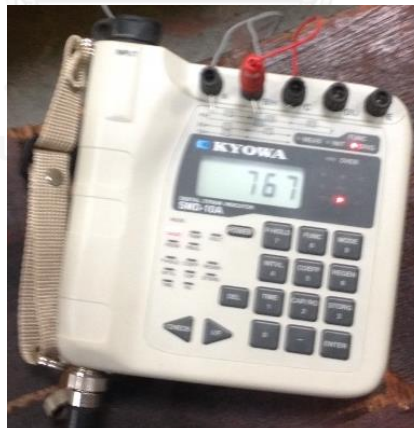
รูปที่ ช-6 แสดง Data Logger ที่ใช้ในการทดลอง
