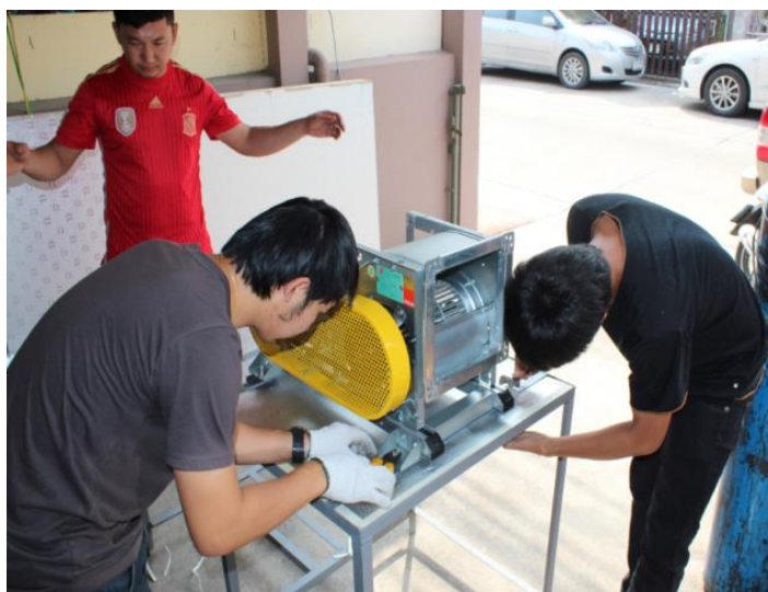
รูปที่ 4.26 แสดงการติดตั้งพัดลม
