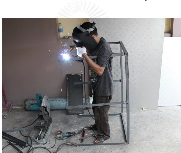
รูปที่ 4.21 แสดงการเชื่อมเหล็กฉากในส่วนฐานของเครื่องฮีทปั๊ม
