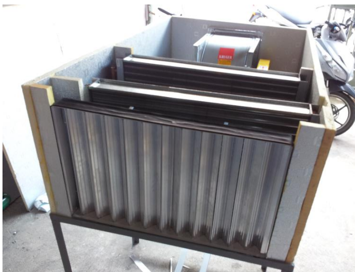
รูปที่ 4.28 แสดงด้านหลังของเครื่อง พร้อมตัวปรับปริมาณลม
