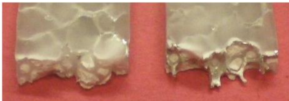
รูปที่ 2. 31 แสดงการแตกหักของวัสดุผสมจากโฟมอะลูมิเนียม และพอลิเมอร์ [23]
