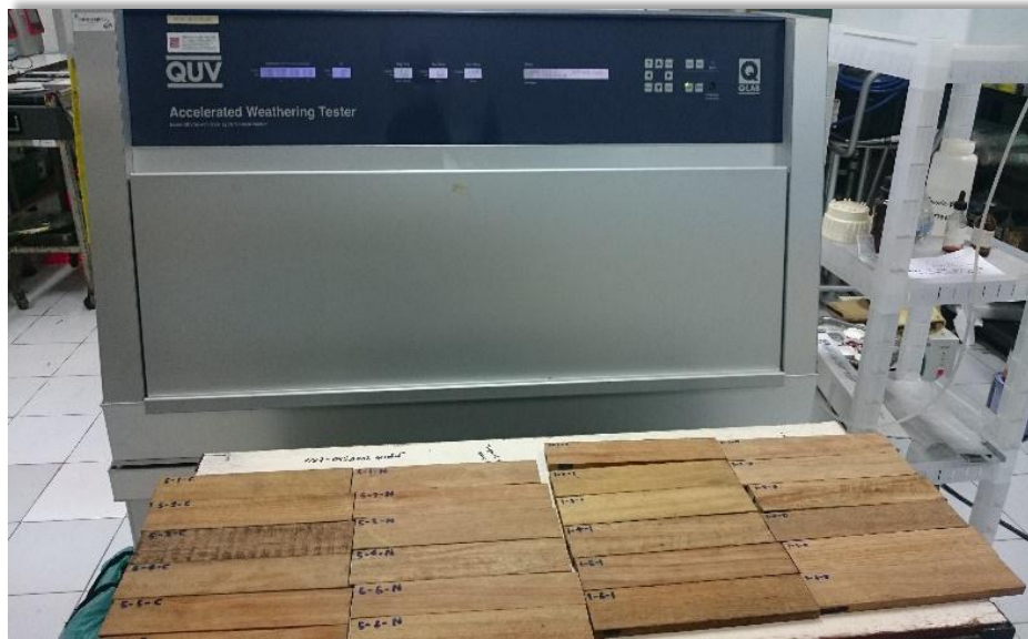
ภาพที่ 3. 3 ชั้นทดสอบและเครื่องเร่งปฏิกิริยาจำลองสภาพอากาศ
