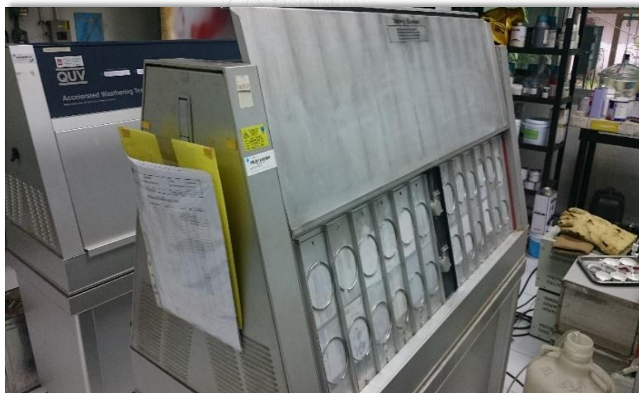
ภาพที่ 3. 4 แนวการวางชั้นทดสอบในเครื่องเร่งปฏิกิริยาจำลองสภาพอากาศ
