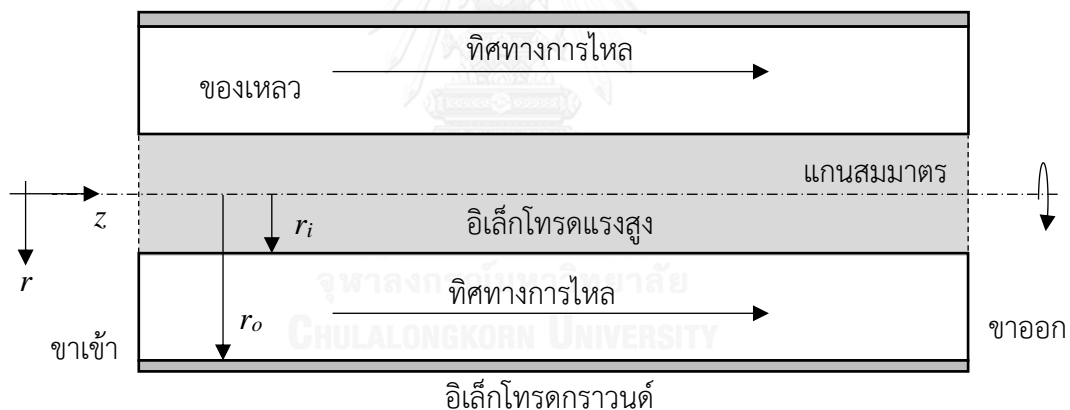
รูปที่ 3.1 แบบจำลองห้องฆ่าเชื้อชนิดทรงกระบอกซ้อนแกนร่วม
