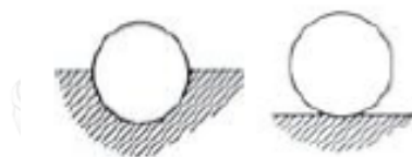
ภาพที่ 2.11 ลักษณะการกดทดสอบความแข็งบริลเนลล์ที่ไม่ถูกต้อง [18]
