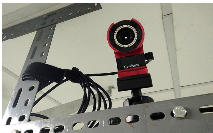
รูปที่ 3.2 กล้องอินฟราเรดที่ติดตั้งเรียบร้อยแล้ว
