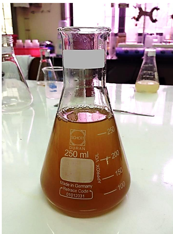
รูปที่ 4.10 สีที่เปลี่ยนแปลงทันทีของสารละลายกรดซัลฟิวริกที่ทำปฏิกิริยากับผงเซลลูโลส ที่สภาวะการทดลองกรดซัลฟิวริกความเข้มข้น 65 %wt. ที่อุณหภูมิ 65 องศาเซลเซียส
