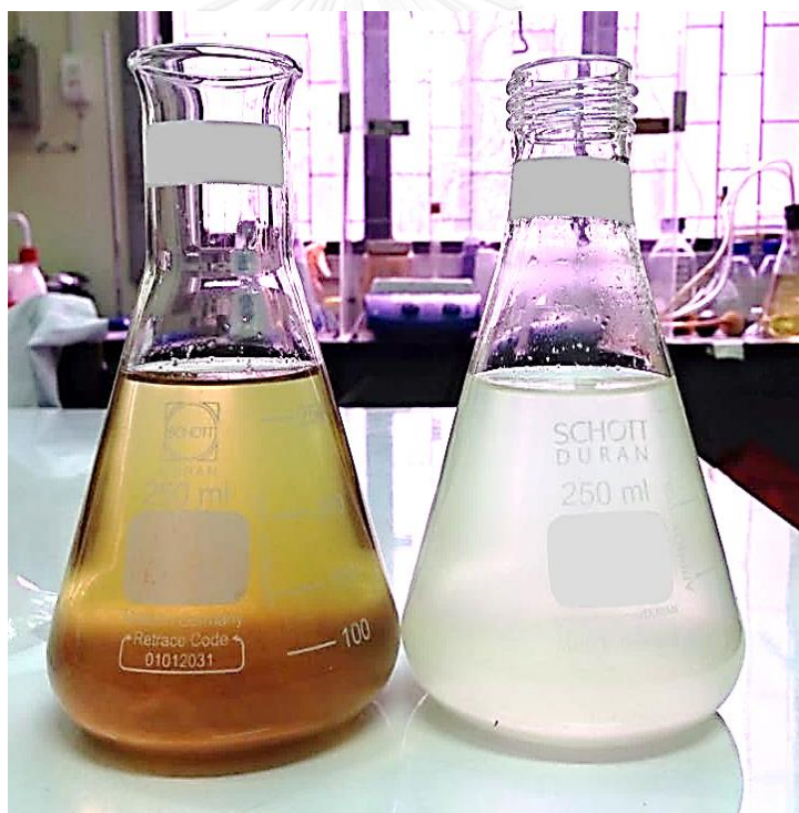
รูปที่ 4.6 สีของสารละลายที่เปลี่ยนไปเมื่อทดลองที่ความเข้มข้นกรดซัลฟิวริก 60 %wt. โดยเปรียบเทียบที่ อุณหภูมิการทดลองที่ 65 องศาเซลเซียส ที่เวลาไฮโดรไลซิส 30 นาที (ซ้าย) และ อุณหภูมิการทดลอง 55 องศาเซลเซียส ที่เวลาไฮโดรไลซิส 30 นาที (ขวา)
