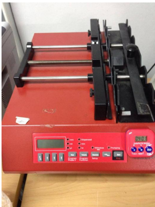
รูปภาพ ค.5 ปีมสำหรับสร้างอัตรการไหล รุ่น NE-1600/NE-1800
