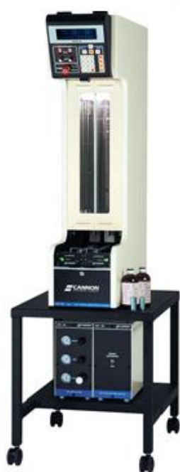
รูปที่ 3.6 เครื่องวัดความหนืดแบบอัตโนมัติที่ใช้ในการทดลอง (Cannon, CAV-2000)
