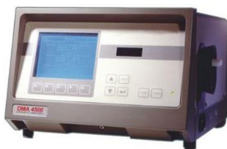
รูปที่ 3 4 เครื่องวัดความหนาแน่นแบบอัตโนมัติที่ใช้ในการทดลอง (Anton Paar, DMA 4500)
