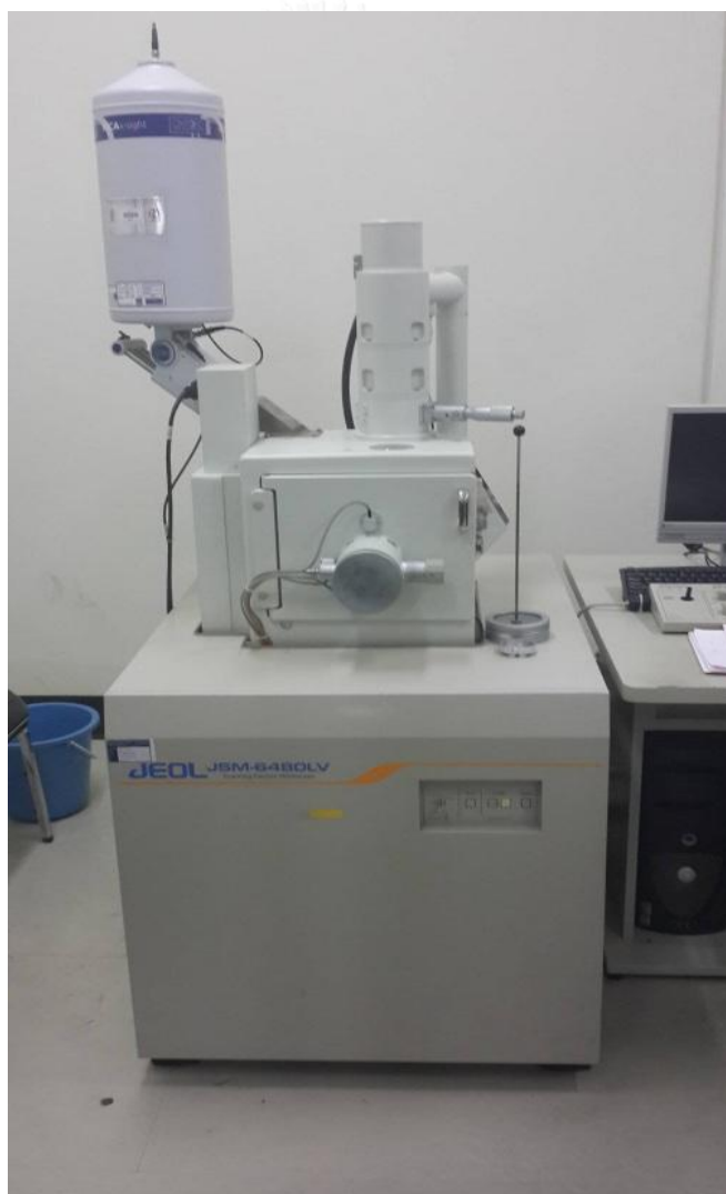
รูปที่ 3.1 เครื่อง SEM ของ JEOL รุ่น JSM-6400
