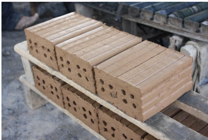
ภาพที่ 2.4 อิฐดินเผาที่ผ่านการขึ้นรูปโดยการรีด
