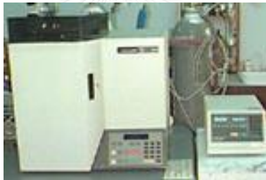
ภาพที่ 3.11 เครื่องเอกซเรย์ฟลูออเรสเซนซ์
