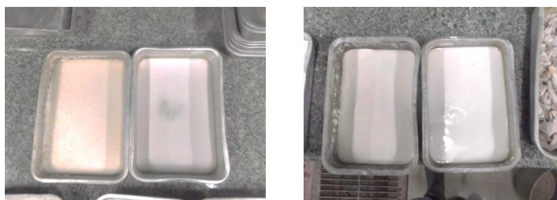
รูปที่ 4.4 ลักษณะของผลิตภัณฑ์ที่ลอยขึ้นมาพร้อมฟองอากาศ (Floated product) และผลิตภัณฑ์ที่จมอยู่ (Sink product) ในการลอยแร่ที่ pH 2 และ pH 10 ตามลำดับ
