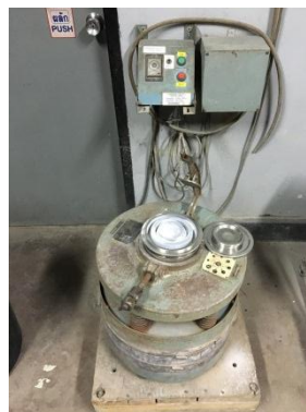
รูปที่ 3.9 เครื่องบด Laboratory disc mill ยี่ห้อ Kawasaki
