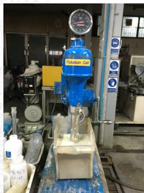
รูปที่ 3.8 เซลล์ลอยแร่ขนาดทดลอง 4 ลิตร ในห้องปฏิบัติการ ยี่ห้อ Denver รุ่น D12
