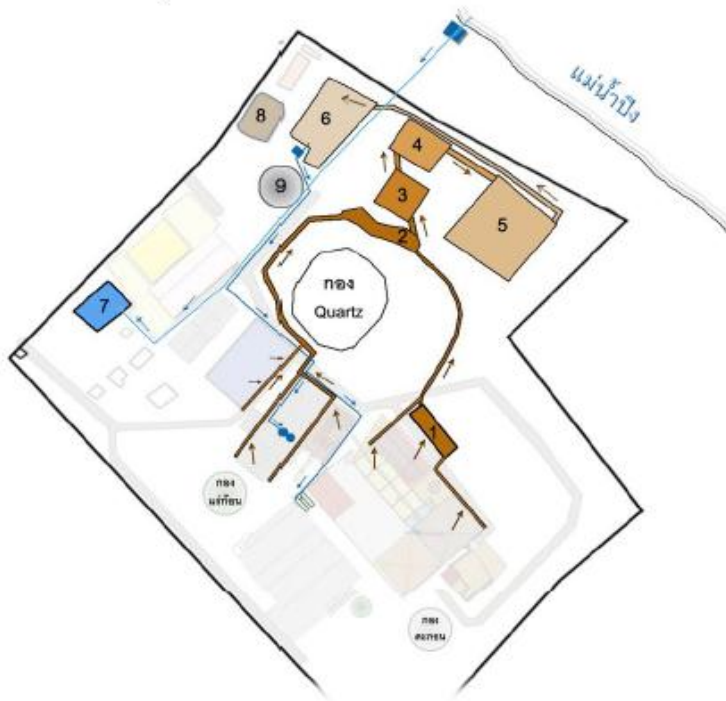
รูปที่ ก1. แผนผังบ่อดกตะกอน แสดงการเก็บขังมูลดินทรายและน้ำหมุนเวียนของบริษัท ออรรูนิอินเตอร์เนชั่นแนล จำกัด
