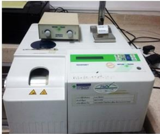
รูปที่ 3.14 เครื่องวิเคราะห์น้ำหนัภายใต้ความร้อน
