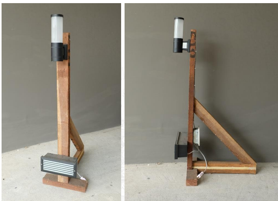
ภาพที่ 3.10 ชุดดวงโคมพร้อมสวิตช์เปิด-ปิด
