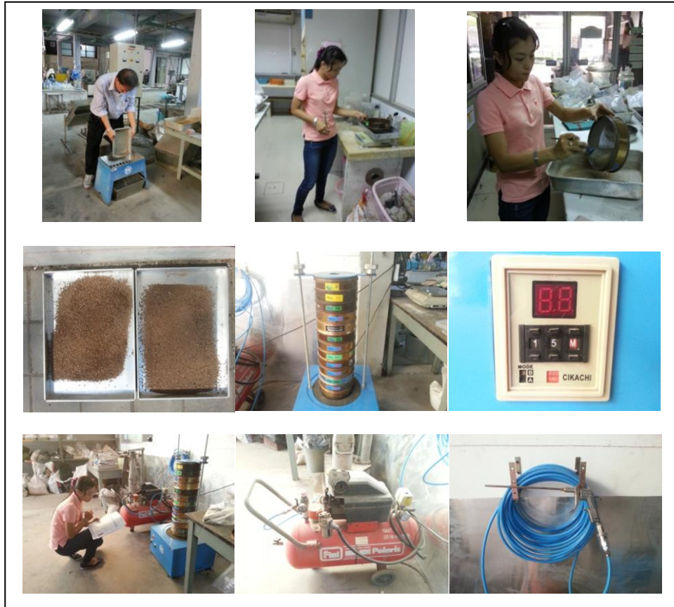
รูปที่ 4 - 19 การทดลองหาขนาดของเม็ดดินในห้องปฏิบัติการ
