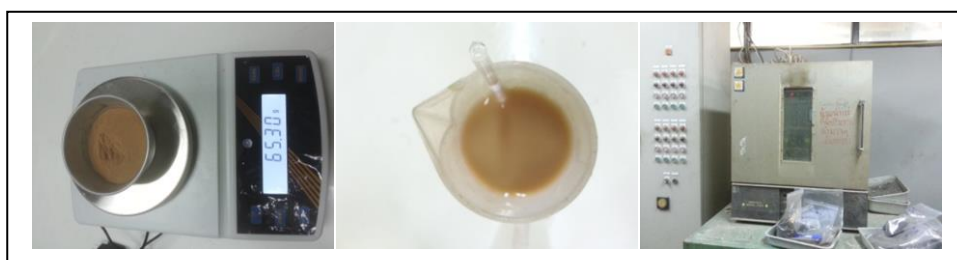
รูปที่ 4 - 21 การทดลอง Hydrometer analysis ในห้องปฏิบัติการ
