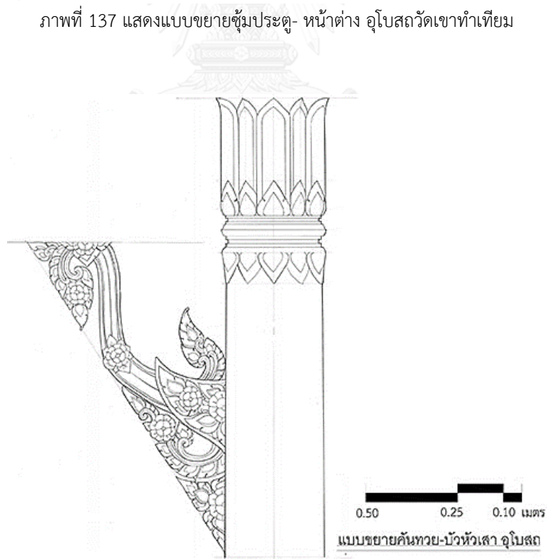
ภาพที่ 138 แสดงแบบขยายคันทวย-บัวปลายเสา อุโบสถวัดเขาทำเทียม
